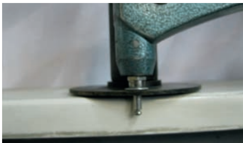
شکل ۱۳-۷ جا زدن میخ پرچ داخل سوراخ
