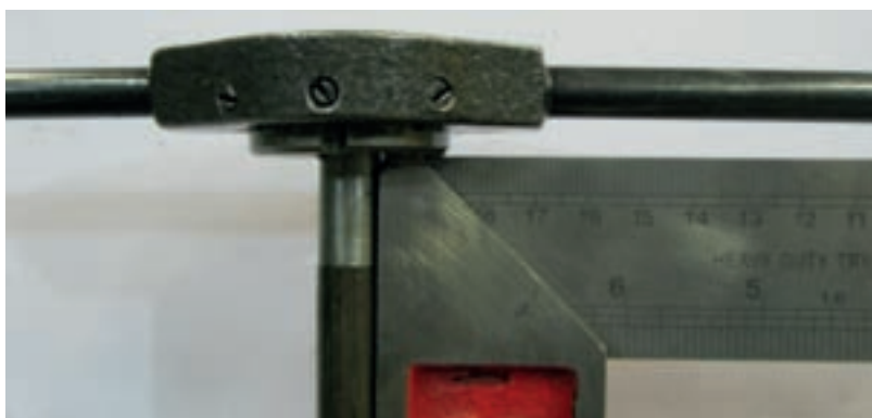
شکل ۶-۱۳ کنترل عمود بودن محور میله با دسته حدیده
