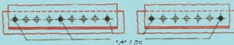
شکل ۱۶-۷ ترتیب پرچکاری قطعات بلند
