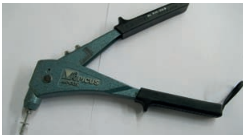
شکل ۱۲-۷ جا زدن میخ پرچ روی انبر پرچ
