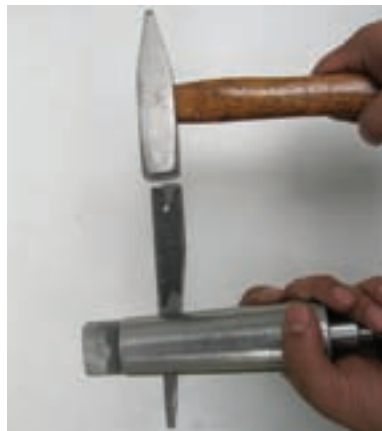
برای نصب مته توسط کلاهک سطح مخروط مته و داخل کلاهک را تمیز می‌کند و سپس مته را داخل کلاهک جا می‌زنند. همچنین با استفاده از گوه و چکش نیز می‌توان مته را از داخل کلاهک خارج کرد (شکل ۲۷-۵).
