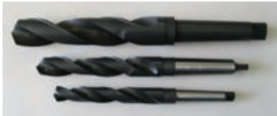
دنباله‌مته‌های مارپیچی که قطرشان بیشتر از ۱۳mm است، معمولاً به صورت مخروطی ساخته می‌شود. دنباله این مته‌ها یک مخروط با شیب کم است که اندازه شیب آنها استاندارد است. این مخروط‌ها، مخروط مورس نامیده می‌شوند. در انتهای مته دنباله مخروطی زبانه‌ای وجود دارد که از آن برای جلوگیری از چرخش مته استفاده می‌شود. همچنین برای خارج کردن مته نیز می‌توان از این زبانه کمک گرفت (شکل ۱۳-۵).
