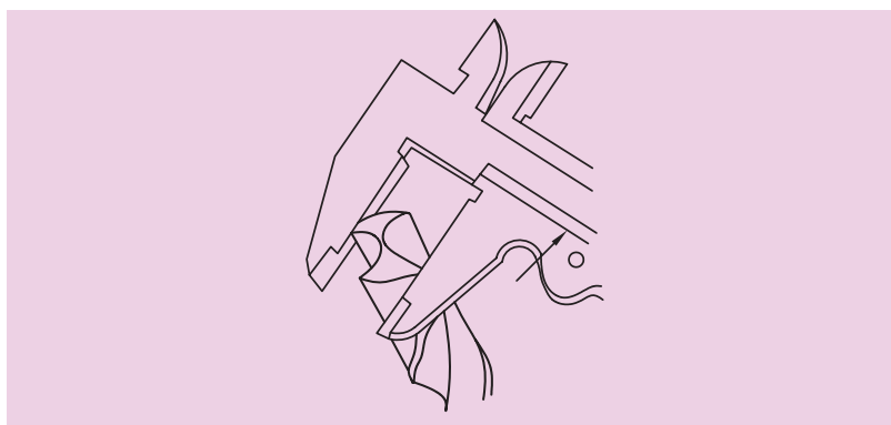
▶ فاز مته: برجستگی نازکی که در کنار شیار مته وجود دارد، فاز مته نامیده می‌شود. فاز مته موجب کاهش اصطکاک بین سطح مته و دیواره سوراخ می‌گردد. همچنین هدایت مته در داخل سوراخ بهتر انجام می‌گیرد. توجه کنید که قطر مته‌ها در هر صد میلی‌متر از طول، یک‌دهم میلی‌متر کوچک‌تر ساخته می‌شود تا در هنگام سوراخ‌کاری سوراخ‌های عمیق از تماس مته با دیواره سوراخ جلوگیری شود. به همین دلیل قطر مته‌ها را باید در سر آنها و از روی فاز اندازه‌گیری کرد (شکل ۵-۶).
