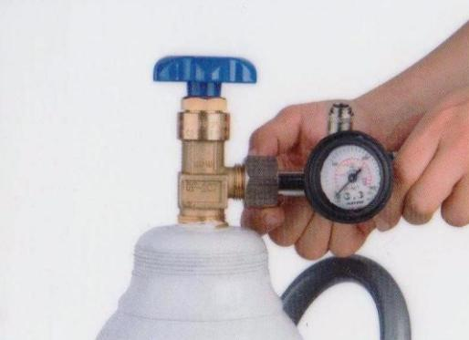
۱ رگولاتور دستگاه را به کپسول اکسیژن متصل کنید (ترجیحاً بدون استفاده از آچار)
