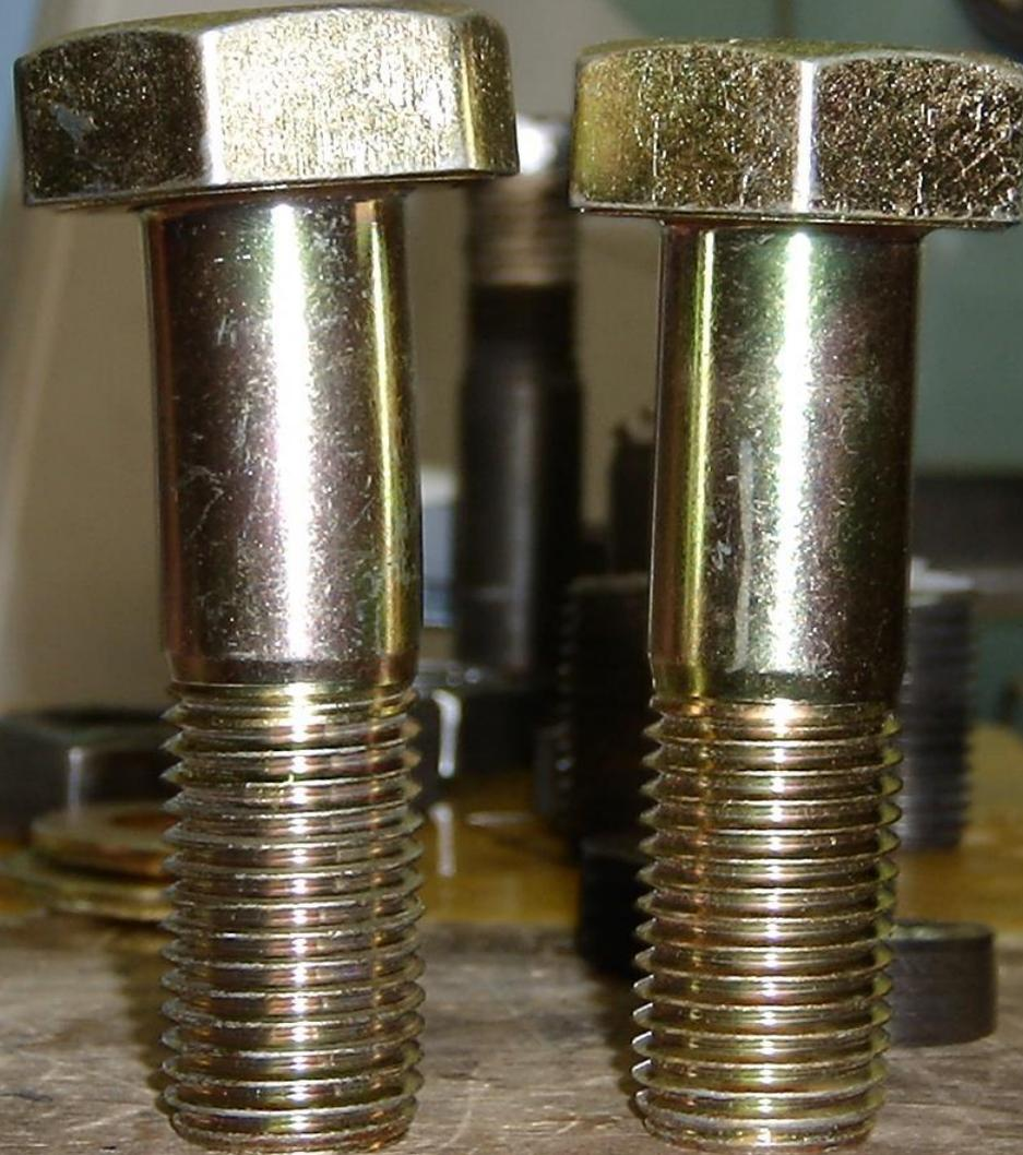
آزمایش کشش بر روی نمونه ماشین کاری شده در موافقی که به دلیل محدودیت ظرفیت دستگاه آزمایش یا کوتاه بودن طول پیچ، امکان انجام آزمایش کشش در اندازه واقعی وجود ندارد، آزمایش کشش بر روی نمونه ماشین کاری شده انجام خواهد شد. محل تهیه دمبل ماشین کاری شده را از مقاطع پیچ های قطور شاهد هستید. در این پیچ ها تهیه نمونه نبایستی از مقطع وسط پیچ صورت پذیرد
