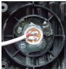
شکل ۴۰- یک نمونه اتصال درست سیم به پایه‌های کپسول میکروفن خازنی
