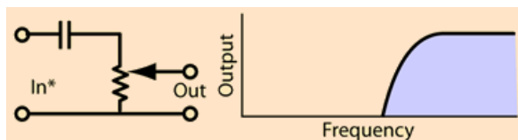
شکل ۶۰ - ساختار اساسی یک فیلتر بالاگذر
