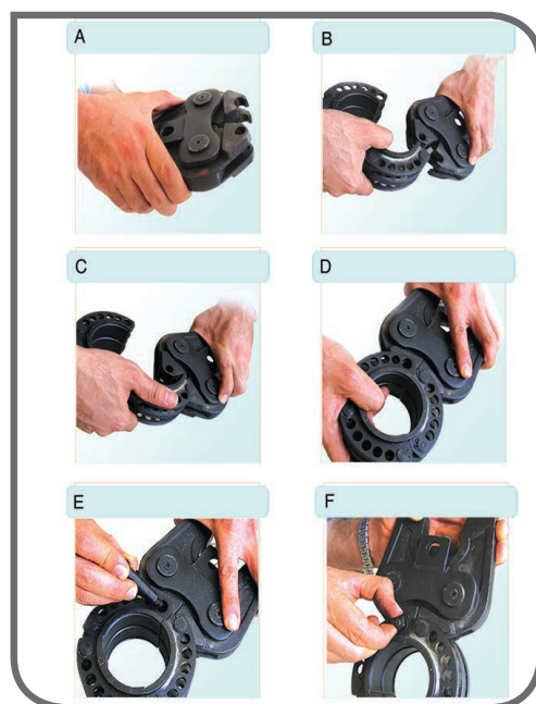
طریقه نصب قالب ۶۳ بر روی فک اختصاصی آن
