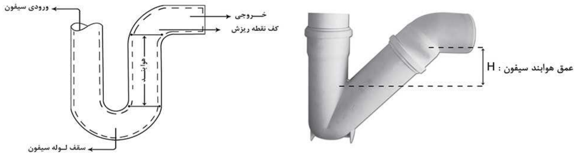
شکل ۷ : شکل سیفون های پوش فیت یک تکه
