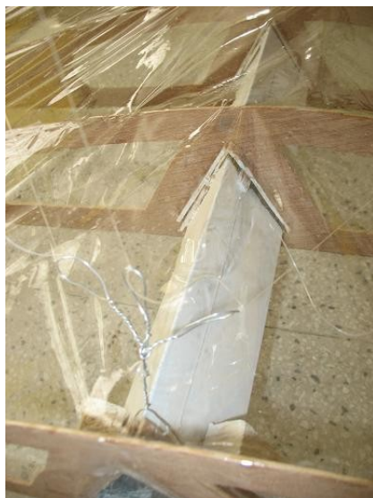
شکل دوازده : سیم های استحکام و صلب شدن سازه
