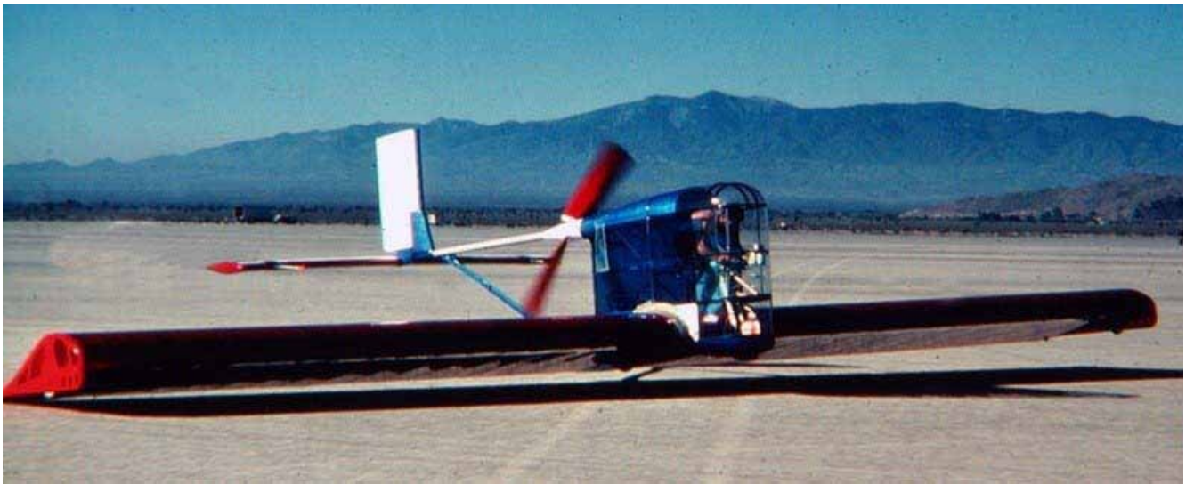
شکل سه : استفاده از اثر زمین در هواپیمای Icarus ساخت سال 1977
