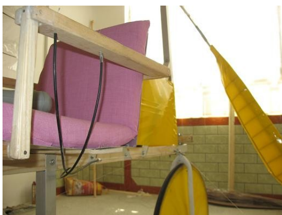
شکل هشت : سیم کشی کنترل هواپیما
