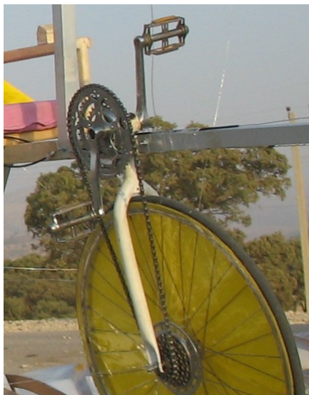
شکل یازده : سازوکار انتقال قدرت به چرخ جلو
