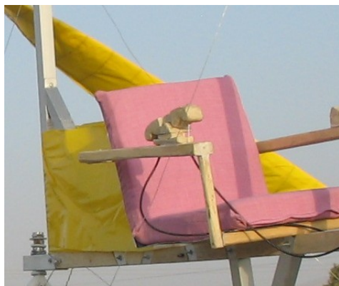
شکل هفت : سازوکار جدید الکلنگی چوبی برای کنترل
