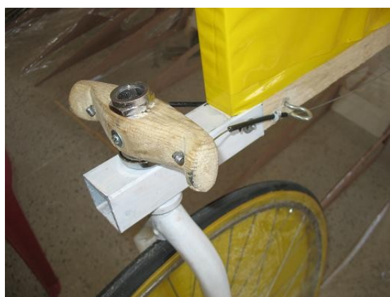
شکل هفت : سازوکار جدید الکلنگی چوبی برای کنترل
