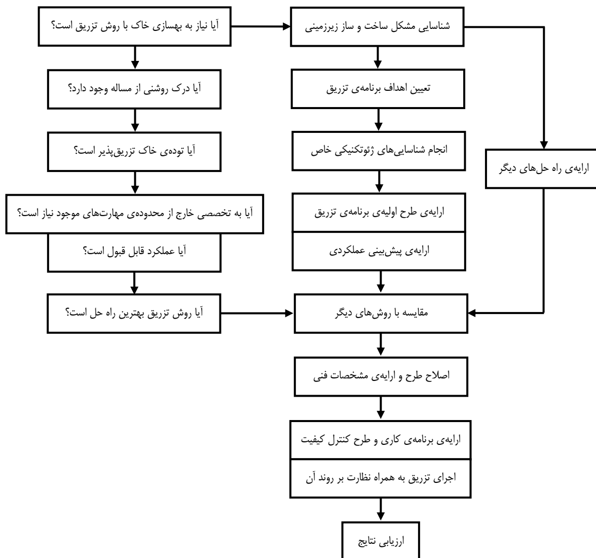
شکل ۸-۴- روندنمای گام‌های مختلف روش تزریق
