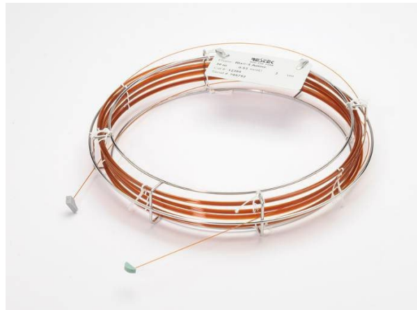
شکل ۲-۱۲- ستون موئین در کروماتوگرافی گازی
