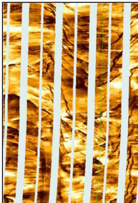
شکل ۷-۸- یک نمونه تصویر حاصله از نمودار FMI را نشان می‌دهد.
