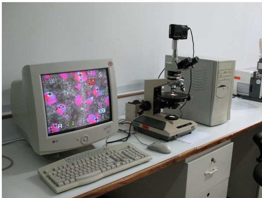
شکل ۴-۱۰- نمای از میکروسکوپ مجهز به دوربین دیجیتالی جهت تهیه تصاویر میکروسکوپی
