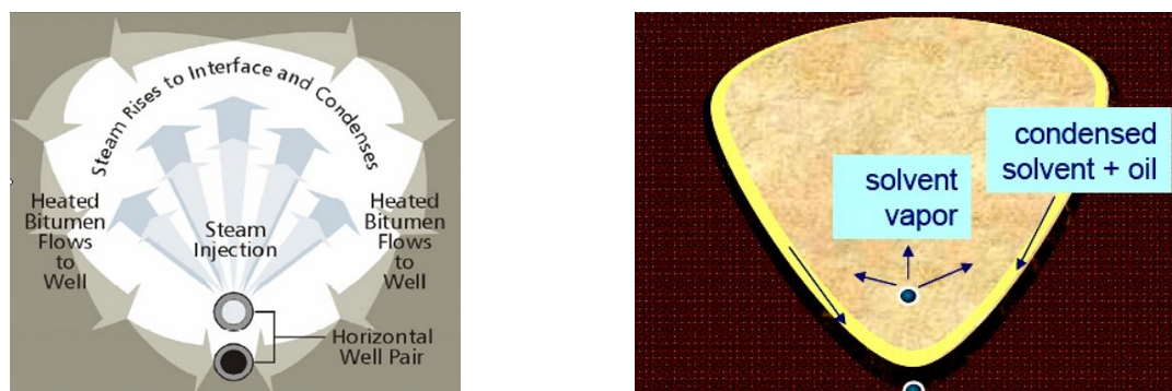
شکل ۸-۱۰- روش بخارات هیدروکربنی در مقایسه با روش ریزش ثقلی
