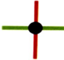
شکل 5-7 نمایش تماس مدفون در تکنولوژی nMOS
