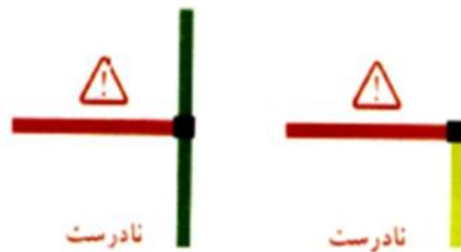
شکل 5-6 عدم اتصال لایه پلی سیلیکون با لایه های نفوذی n و p
