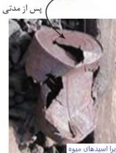
شکل رو به رو بخشی از یک ورقه آهنی راشن می‌دهد که با لایه نازکی از قلع پوشیده شده است. به این نوع آهن، حلبی می‌گویند. از ورقه‌های حلبی برای ساختن قوطی‌های کنسرو و روغن نباتی استفاده می‌شود.
