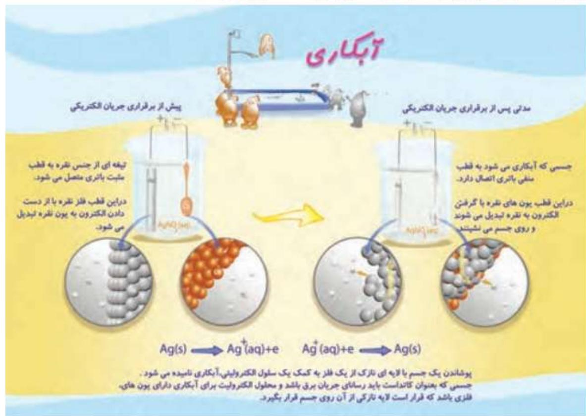
می خواهیم روی قاشق مسی روکشی از نقره قرار بگیرد بنابراین قاشق را در کاتد سلول الکتروولیتی قرار داده تیغه از نقره را در آند قرار می دهیم محلول الکتروولیت را یکی از نمک های محلول نقره ای انتخاب می کنیم در آند یون های نقره از تیغه جدا شده و در کاتد این یون ها با دریافت الکترونبر ر روی قاشق مسی می نشینند
