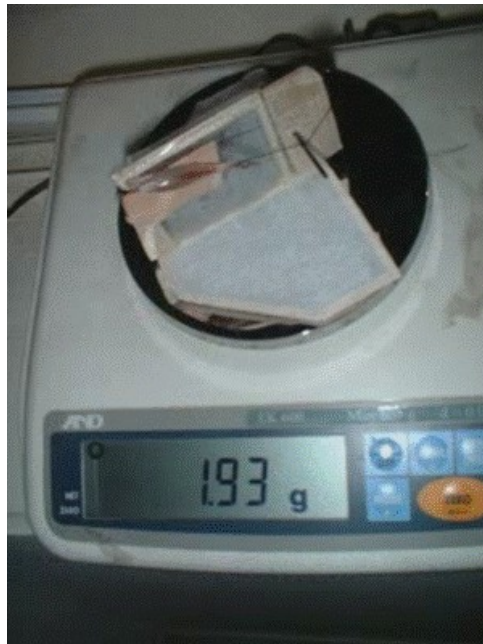
شکل ۷۷ وزن ریزپرنده ساخته شده توسط دانشگاه صنعتی شریف؛ میزان سبکی اجزای ریزپرنده ساخته شده چشمگیر است.
