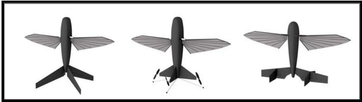
شکل ۸۳ پیکربندی های متفاوت مشابه موارد استفاده شده طی فاز اول برای شروع بررسی اثرگذاری سامانه کنترل پیش از طراحی بدون دم
