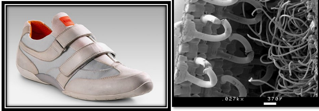
شکل ۵۸ راست: چسب های ولکرو به کار رفته در کفش های ورزشی چپ: ریزساختار مکانیزم چسبیدن قلاب های دو لایه چسب ولکرو به هم
