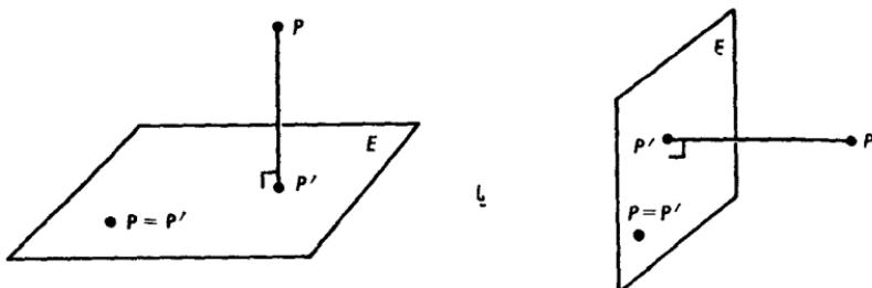
طبق قضیه ۹-۸، چنین عمودی وجود دارد و یکتاست. در هر یک از این شکلها  $P'$  تصویر  $P$  بر صفحه  $E$  است.  $P$  می‌تواند در  $E$  باشد، در این صورت تصویر  $P$ ، خود  $P$  است.
