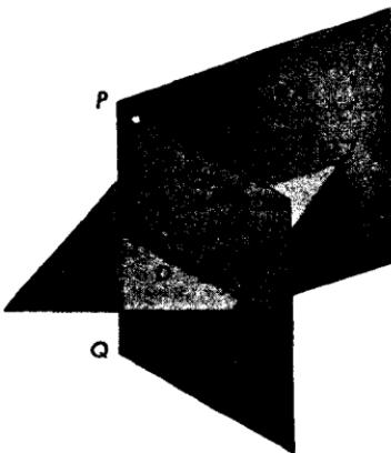
در این شکل علامت نشان می‌دهند که  $\angle PYD$  و  $\angle PYC$  قائم‌اند. یعنی صفحه شامل  $\angle CYD$  در Y بر  $\overline{PQ}$  عمود است. طبق تعریف بالا،  $\angle CYD$  زاویه مسطحه  $\angle A-PQ-B$  است.
