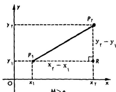
اگر شیب یک پاره خط مثبت باشد، شیب آن با نسبت دو پاره خطی که شکل سمت راست بالا نشان می‌دهد برابر است. در اینجا  $x_2 > x_1$  و  $y_2 > y_1$ ، و داریم  $RP_2 = y_2 - y_1$  و  $P_1R = x_2 - x_1$ . (چرا؟) بنابراین
