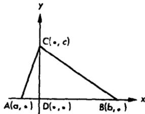
۹ در هر مثلث مجدد ضلع مقابل به زاویه حاده برابر است با مجموع مجددهای دو ضلع دیگر منهای دو برابر حاصل ضرب یکی از این دو ضلع در تصویر ضلع دیگر براین ضلع. یعنی ثابت کنید:  $AC^2 = AB^2 + BC^2 - 2AB \cdot DB$ . در چه مرحله‌ای از برهان، به حاده بودن  $\angle B$  نیاز دارید؟
