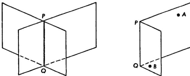
از برخورد این دو صفحه چهار شکل به دست می‌آید که هر کدام مانند شکل سمت راست بالا هستند. چنین شکلی را فرجه، یا زاویه دووجهی، و خط  $\overline{PQ}$  را با آن می‌نامند.
