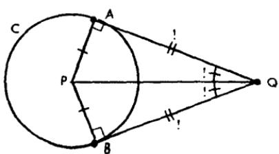
بیان ریاضی. دایرة  $C$  به مرکز  $P$ ، و نقطه  $Q$  بیرون آن مفروض است. اگر  $\overline{QA}$  و  $\overline{QB}$  در دو نقطه  $A$  و  $B$  بر  $C$  مماس باشند، آن گاه  $QA = QB$  و  $\angle PQA \cong \angle PQB$ .
