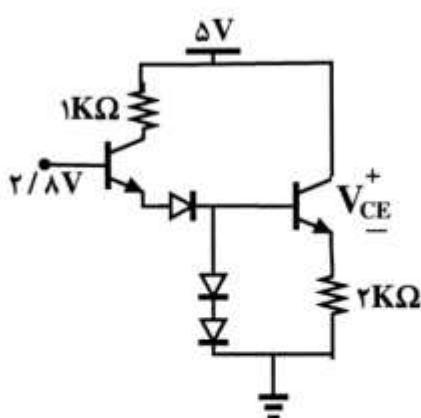
۱۰۰- در مدار شکل زیر ولتاژ  $V_{CE}$  چند ولت است؟ ( $V_{BE} = 0.7V$ )
