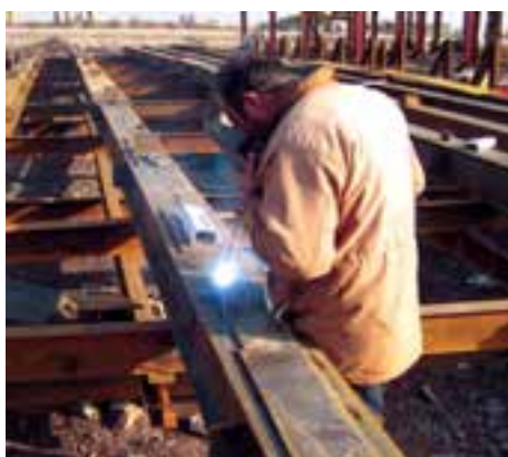
شکل ۴-۱۵- جوشکاری ستون جفت (وی شاسی کار)
