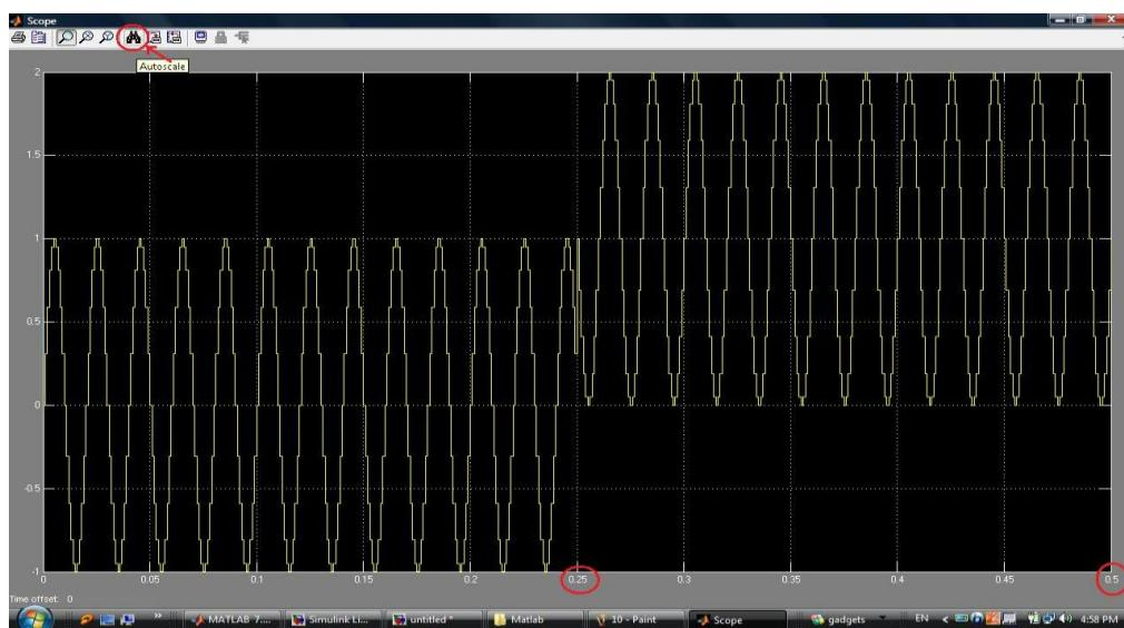
با کاهش sample time در موج سینوسی می‌توان به شکل دقیق‌تری دست یافت.
