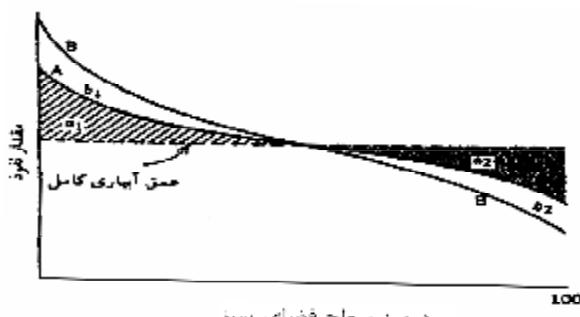
شکل 2-7- فراوانی تجمعی توزیع آب برای دو سیستم آبیاری که در آنها کفايت آبیاری یکسان می‌باشد.
