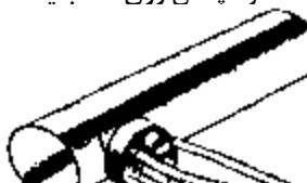
شکل ۱-۱۱: یک قطره چکان روی خط با چند خروجی
