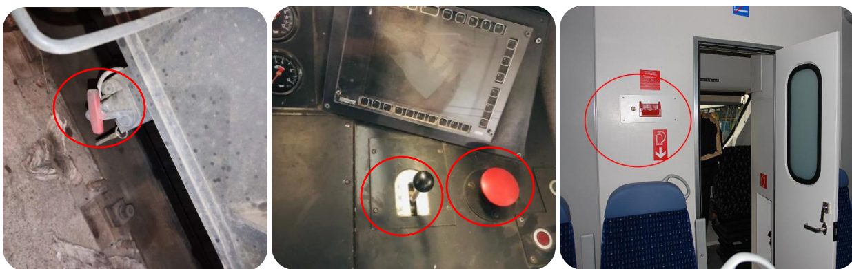
شکل ۹ ترمز اضطراری مسافری (سمت راست) - ترمز اضطراری واگن و اهرم مستر کنترلر (شکل وسط) - اهرم ترمز پارک (شکل سمت چپ)
