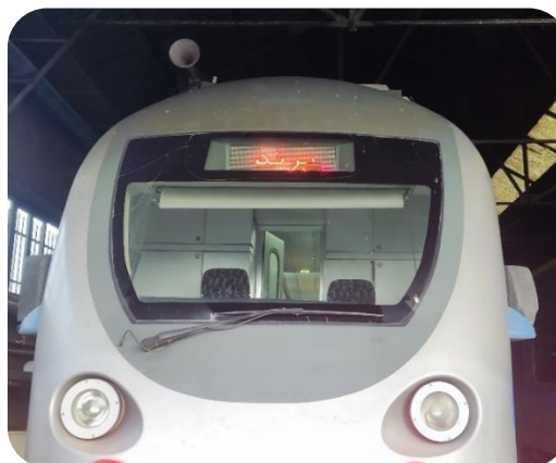
شکل ۳۱ نمایشگر پیشانی نشان دهنده مقصد (سمت راست) - کنترلر نمایش اطلاعات (IDC) (سمت چپ)
