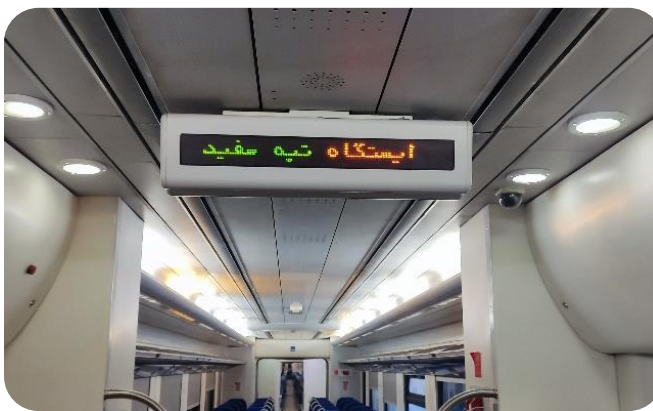
شکل ۳۰ نمایشگر اطلاعات مسافرین (PIB) (سمت راست) - نمایشگر نشان دهنده مقصد (سمت چپ)
