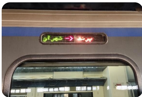
شکل ۳۰ نمایشگر اطلاعات مسافرین (PIB) (سمت راست) - نمایشگر نشان دهنده مقصد (سمت چپ)
