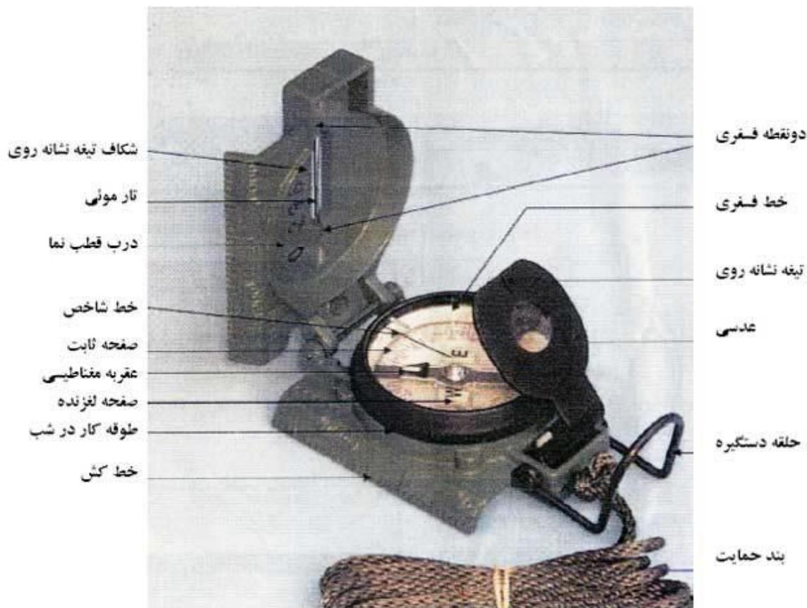
**۱- دستگیره یا شصتی:** حلقه ای است که در انتهای قطب نما قرار دارد و برای نگهداشتن قطب نما به حالت تراز در موقع استفاده به کار می رود.
