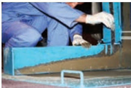
شکل ۴- نمونه‌ی اجرای آزمایشگاهی بتن خود تراکم
