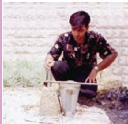
اجرای آزمایش اسلامپ برای تعیین میزان کار آبی بتن
