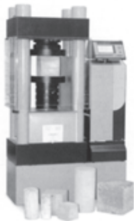
نمونه‌هایی از دستگاه‌های آزمایش مقاومت فشاری بتن که صفحه‌ی نمایش آن‌ها با به صورت عقربه‌ای و یا دیجیتالی است.
