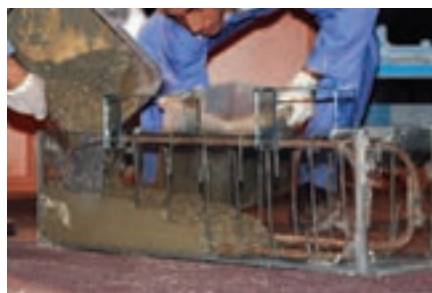
شکل ۴- نمونه‌ی اجرای آزمایشگاهی بتن خود تراکم
