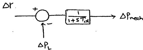
که  $T_{CH}$  ثابت زمانی شارژ توربین و  $\Delta P_{valve}$  تغییرات موقعیت شیر بخار است.
