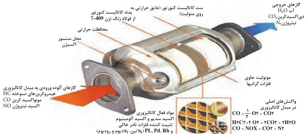
شکل ۳-۱۱ بخش های تشکیل دهنده یک مبدل کاتالیست
