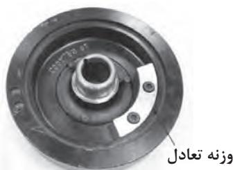
الف) اتصال وزنه بر روی پولی جهت بالانس (فلاپلایویل)
