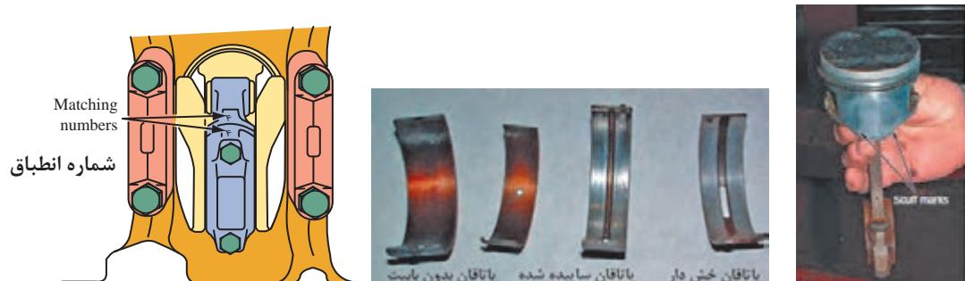
کنترل ساییدگی پیستون و یاتاقان‌ها و شماره روی شاتون
