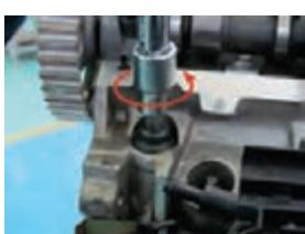
جهت باز کردن پیچ های سرسیلندر
