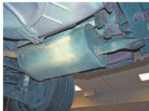
شکل ۳-۳۵ اتصال انباره اگزووز توسط بستهای نگهدارنده لاستیکی
