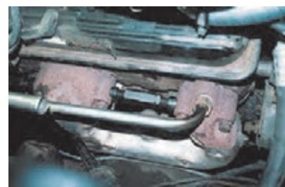
تصویر نشتی دود بین مانیفولد و سرسیلندر
