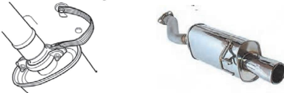
با باز کردن بستهای و اتصالات منبع اگزوز می‌توانید آن را از روی خودرو بیاده کنید. انباره یا صداخفه کن برای هر خودرو با شکل و ابعاد و محل نصب مخصوص آن خودرو می‌باشد ممکن‌آور فقط تعویض می‌شوند و قابل تعمیر نیستند. (صرع)
