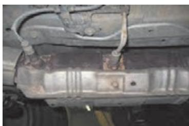
محل نصب حسگر اکسیژن روی مبدل کاتالیست
