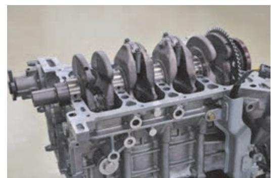
شکل ۲-۲۹ پیچ های اتصال کپه یاتاقان ها و محفظه لنگ
