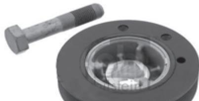
ب) پولی با درگیری تسمه V شکل (ذوزنقه‌ای)
