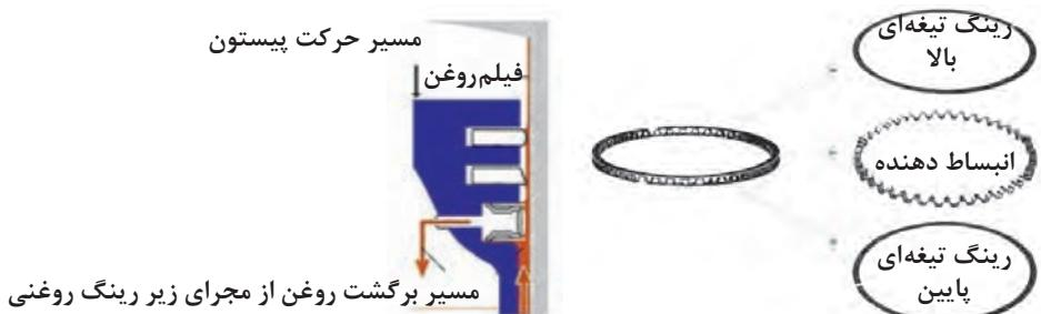
شکل ۲-۵۸ (ب) برگشت روغن به کارتر توسط رینگ روغن
