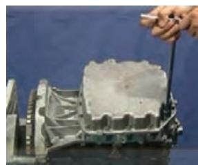
باز کردن صافی روغن ورودی به پمپ
