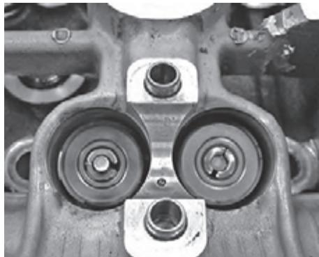
شکل ۱-۱۱۴ نصب نادرست خارهای سوپاپ
