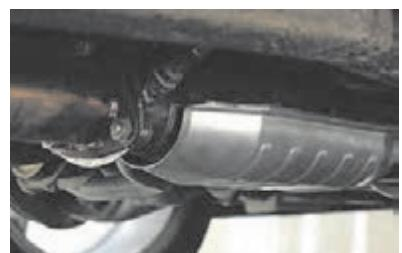
شکل ۳-۲۷ محل نصب سپر حرارتی در سیستم اگزووز
