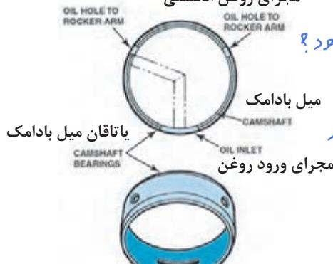
مجرای روغن تعییه شده بر روی یاتاقان میل سوپاپ
