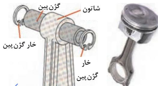
نمایهه نوع اتصال شاتون به پیستون چیست؟ شکل ۲-۳۴
