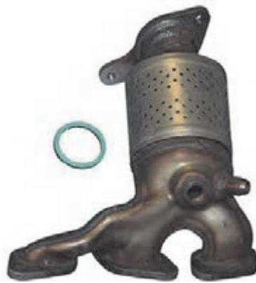
مجموعه مانیفولد خروجی و کاتالیست روی موتور خودرو
