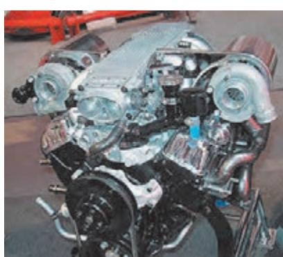
شکل ۴-۳ موتور V شکل
