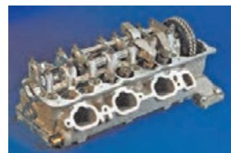
محل نصب مانیفولد خروجی روی سر سیلندر
