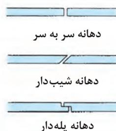
انواع لبه های رینگ های مورد استفاده در موتورهای کم دور و دیزل
