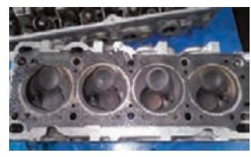
سوختن واشر سرسیلندر و نشتی
