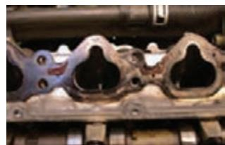
آثار نشتی مانیفولد دود روی سرسیلندر
