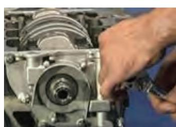
نصب مجموعه روغن بر روی بلوک
