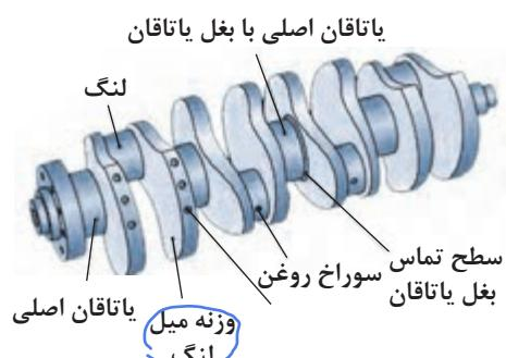
الف) میل لنج با دو وزنه در طرف مقابل لنج
