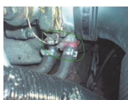
شکل ۲-۱۰-الف) نشتی از لوله ها و پولک اطراف سیلندر
