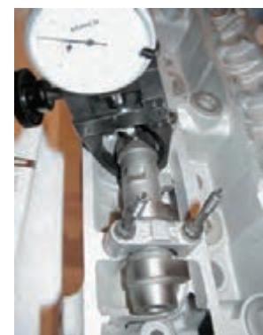
اندازه گیری مستقیم ارتفاع بادامک ها توسط ساعت اندازه گیر مخصوص روی سرسیلندر
