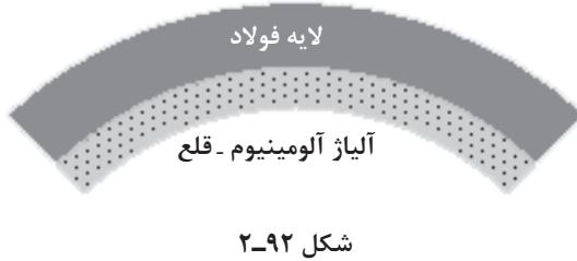
(یاتاقان‌های آلومینیومی برای سرعت‌ها و بارهای بالا به کار می‌رود، آلومینیوم با مقدار کمی قلع و سیلیکون آلیاژ می‌شود که آن را از یاتاقان‌های بابیتی و یا آلیاژ مس-سرپ مقاوم‌تر و لی گران‌تر می‌کند. معمولاً از این نوع یاتاقان‌ها در یاتاقان‌های میل سوپاپ که بارهای بزرگ‌تر و تناویی را تحمل می‌کنند به کار می‌رود (شکل ۲-۹۲)).
