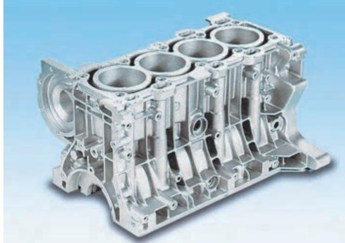
مجموعه نیم موتور یا بلوک سیلندر بخش اصلی هر موتور را تشکیل می دهد اگرچه تعمیرات و تنظیمات در این بخش نسبت به بخش سرسیلندر دشوارتر می باشد ، اما دقیق در سرویس و تعمیرات این بخش نقش بسیار مؤثری در کاهش هزینه های نگهداری خودرو خواهد داشت. علاوه بر آن میزان آلاینده های احتمالی را کاهش خواهد داد.
