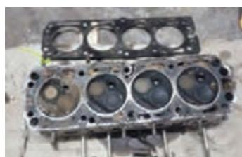
سوختن واشر سرسیلندر و ورود مایع
