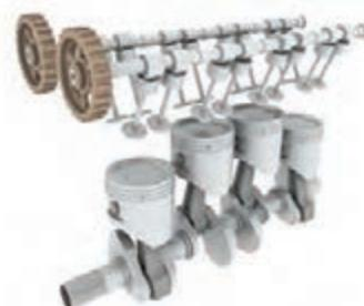
سرسیلندر آلیاژ آلومینیومی با دو میل سوپاپ رو (هر سیلندر بیش از ۲ سوپاپ)
