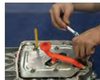
نصب صافی روغن و متعلقات آن بر
