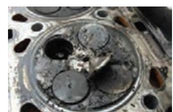
ذوب شدن سوپاپ
