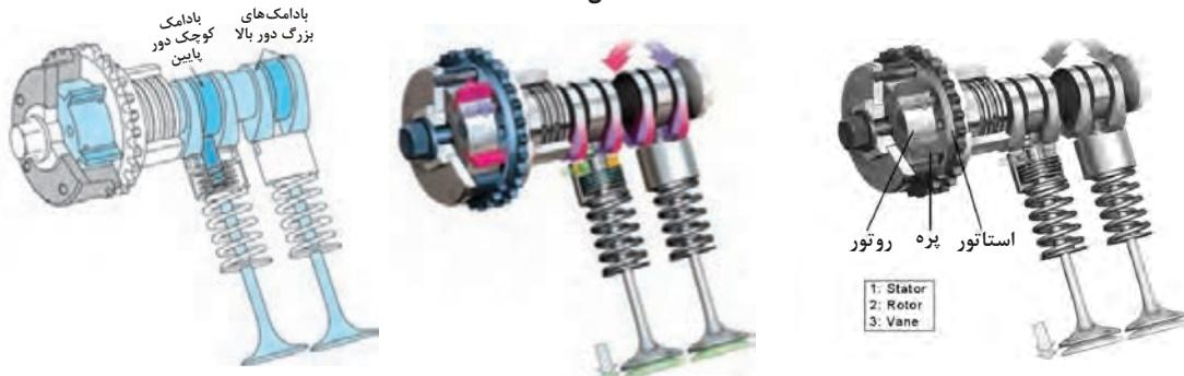
سرسیلندر با مکانیزم تایمینگ متغیر و تغییر ارتفاع باز شدن سوپاپ‌ها (نوع هیدرولیکی با تغییر محرک بادامک کوتاه، بلند و تایمینگ متغیر)
