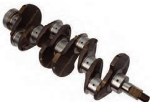
ب) میل لنج با یک وزنه در طرف مقابل لنج
