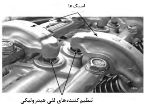
سرسیلندر دارای اسپک های تنظیم کننده هیدرولیکی
