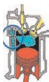
نشتی از محل های مختلف بوش سیلندر و واشر سرسیلندر و بالای بوش
