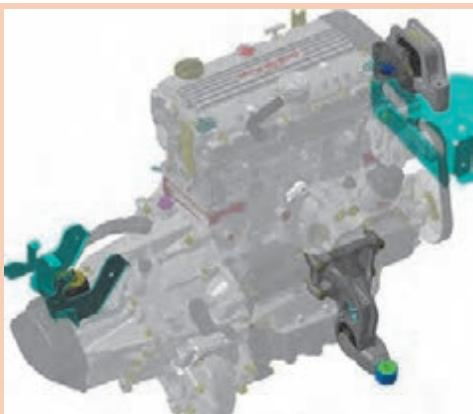
شکل ۲-۷ «صورت فنی» دسته موتورها دیا پارگ لاستیک دسته موتور چه عیوب ایجاد می شود.
