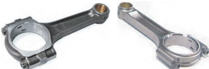
الف) شاتون با روش تولید آهنگری (فرمده‌گرم)      ب) شاتون با روش تولید ریخته‌گری و بوش گزن پین      شکل ۲-۶۹
