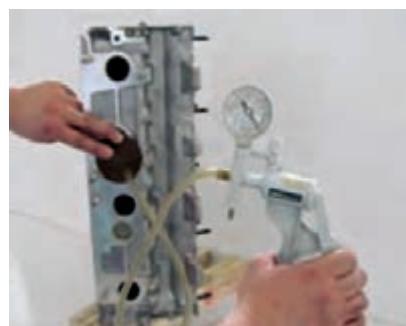
( نشتی سنجی سوپاپ‌ها به وسیله دستگاه خلاً‌سنج )
