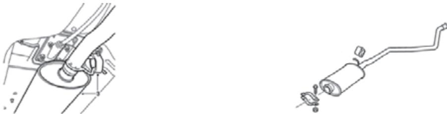
با باز کردن بستهای و اتصالات لوله اگزوز می‌توانید آن را از روی خودرو بیاده کنید. لوله اگزوز با توجه به اتاق خودرو، یک قطعه تخصصی محسوب می‌شود و معمولاً با منبع وسط یکپارچه است و اگر براثر ضربه یا تصادف حالت خودرا ازدست بدهد (خمنا یا له شود) باید تعویض گردد.
