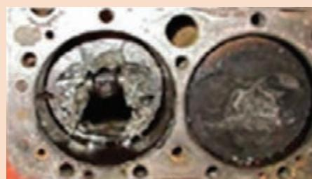
برخورد سوپاپ‌ها به سر پیستون
