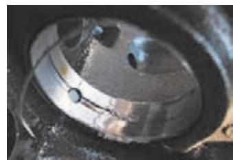
شکل ۲-۱۶۰ خرابی تکیه گاه میل سوپاپ
