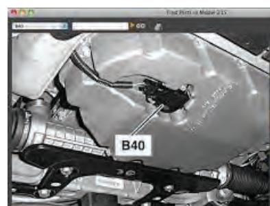
شکل ۴-۱۰ حسگرهای سطح و دمای روغن موتور
