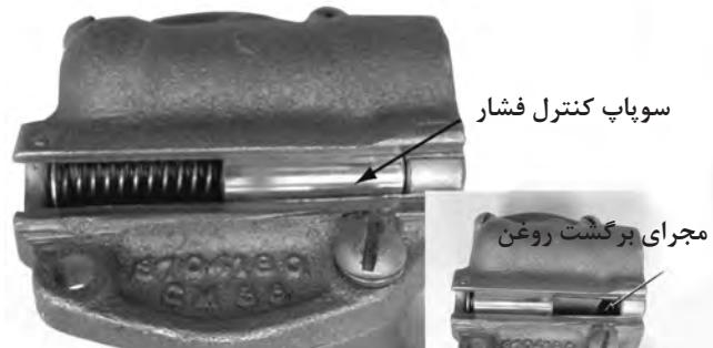
بررسی سلامت اجزای سوپاپ کنترل فشار
