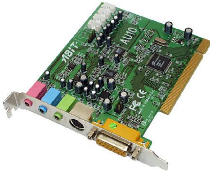
شکل ۲-۲۲: نمای داخلی از کارت صدای رایانه
