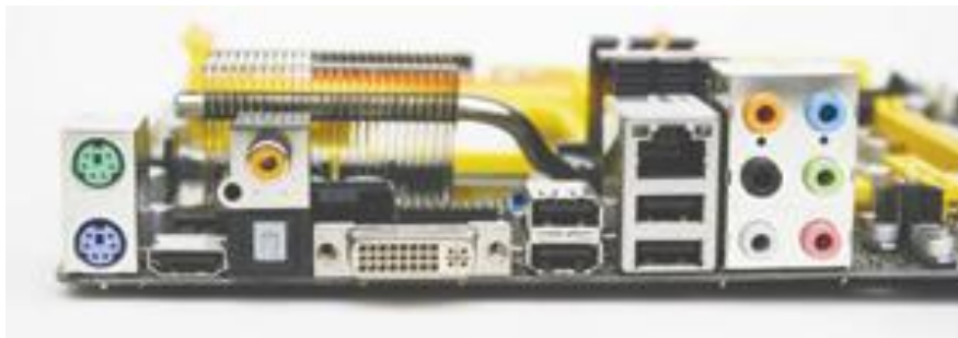
شکل ۲-۲۷: برد اصلی با کارت گرافیک آنبرد
