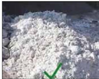
شکل ۱-۳۰ آهک سرند (الک) شده و آماده برای ساخت شفته
