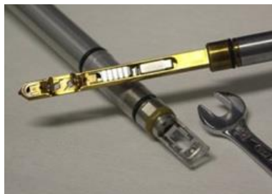
نگهدارنده نمونه در میکروسکوپ الکترونی عبوری
