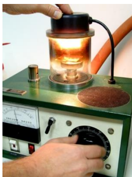
شمایی از دستگاه کندوپاش جهت پوشش دهی نمونه ی SEM از
