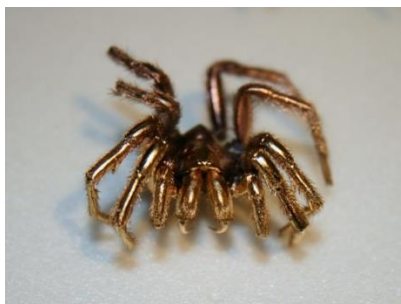
عنکبوت پوشش داده شده با طلا جهت بررسی با SEM
