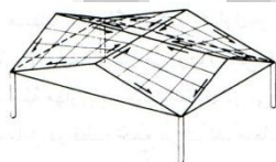
برش در تیرهای مرزی سقف سهموی هذلولی که توسط ستونهای خارجی تحمل می شود
