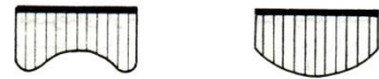
خاک چسبنده (Rigid wall) / خاک غیر چسبنده (Non-rigid wall) پی زیر سطح (Foundation below ground level) / خطوط عمودی نشانگر شدت فشار تماس اند
