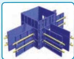
شکل ۳-۲۸- قالب فلزی برای اجرای پی
