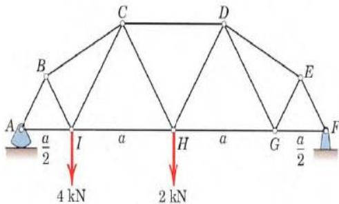
یک خرپای متقاضی مطابق شکل زیر بارگذاری شده است. نیرو در اعضای FG و BC را بدست آورید. محاسبه را با استفاده از یک برش و دو معادله که هر یک فقط شامل یکی از مجھول ها هستند، انجام دهید. آیا نامعین بودن استاتیکی تکیه گاه ها تأثیری در نتایج محاسبه دارد؟
