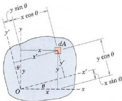
دوران محورها : حاصلضرب اینرسی، هنگام محاسبه  $\bar{I}$  ممان اینرسی سطح حول محورهای مایل، قابل استفاده است. با این بررسی، مستقیماً به مسئله  $\bar{I}$  مهم تعیین محورهایی که ممان اینرسی حول آنها ماقزیم یا می نیم است، رهنمون می شویم. ممان اینرسی های سطح نشان داده شده در شکل زیر حول محورهای مایل  $x'$  و  $y'$  می توان به صورت زیر نوشت :
