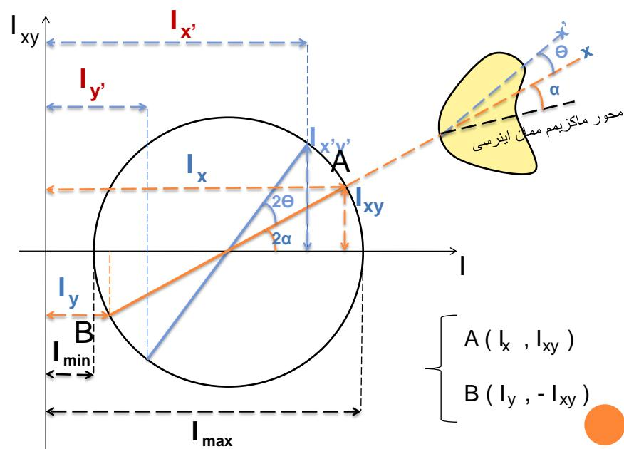
• مثال : برای سطح نبیشی داده شده در شکل محورهای مرکزی اصلی ماند و همچنین لنگرهای ماند ماکریم و مینیمم مریبوطه را محاسبه نمایید.
