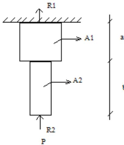
حل : اگرچه دو بخش فوقانی و تحتانی میله از یک جنس (یکسان  $E$ ,  $\gamma$ ) ساخته شده اند ولی سطح مقاطع متفاوت است :
