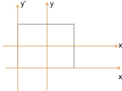
حاصلضرب اینرسی این سطح را نسبت به محورهای x-y می نویسیم و در آن x و y بر حسب مختصات  $x_0$  و  $y_0$  المان سطح  $dA$  نسبت به محورهای مرکزی قرار می دهیم:
