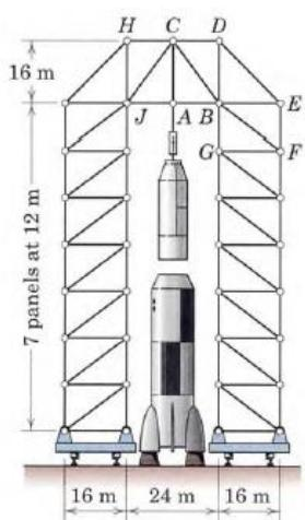
مثال : جهت نصب موشکی به جرم 500 تن و آماده کردن آن برای پرتاب از نوعی پل متحرک استفاده می گردد این پل قسمتی از موشک به جرم 60 تن را که از مفصل A آویزان شده است جابجا می نماید. در عضو AB نیرویی فشاری به اندازه ی 50kN و در عضو CD نیروی کششی به اندازه ی 120kN ایجاد شده است. نیرو در عضو EF را محاسبه کنید.
