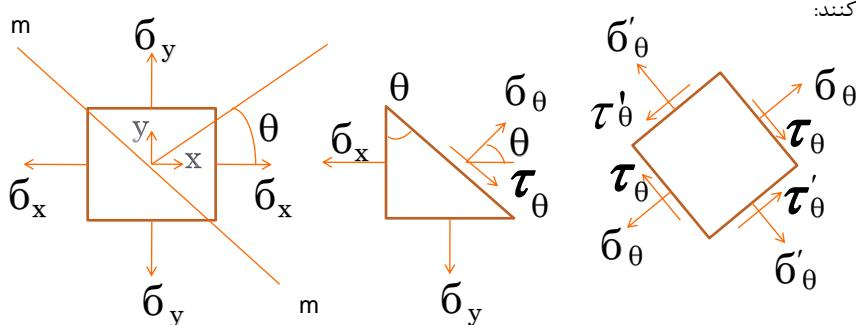
در اینجا جسم تحت تأثیر تنش دو بعدی قرار دارد (دو محوری) مثل مخازن تحت فشار و تیرها و...
