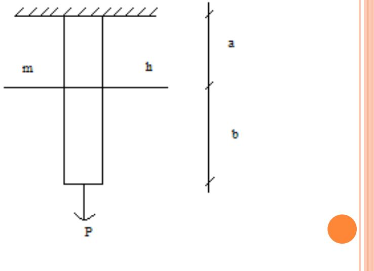
حل: در رابطه با بخش بالایی میله (به درازای a)، وزن بخش زیرین (با درازای b) همراه با نیروی
