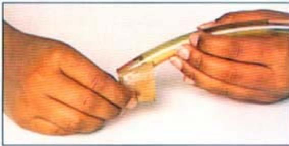
۳- به کمک یک تکه خمیر مجسمه سازی طرف دیگر لوله را کاملاً آب بندي کنید، فقط یک فضا برای حباب هوا باقی بگذارید. به طرفین لوله، به مقدار کافی نوار چسب (بسته بندي) بزنید. این مانع نشست آب و تبخیر آن می شود و در نتیجه سطح آب کاهش نمی یابد.
