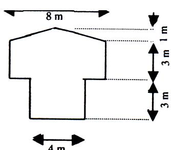
مطلوبست ممان ایندرسی  $I_X$  شکل زیر نسبت به محور گذرنده از مرکز شکل.
