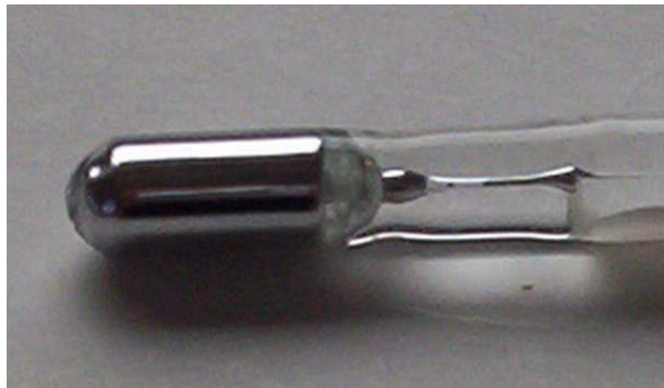
شکل ۱۴: باریک شدن گلوی دماسنج پزشکی
