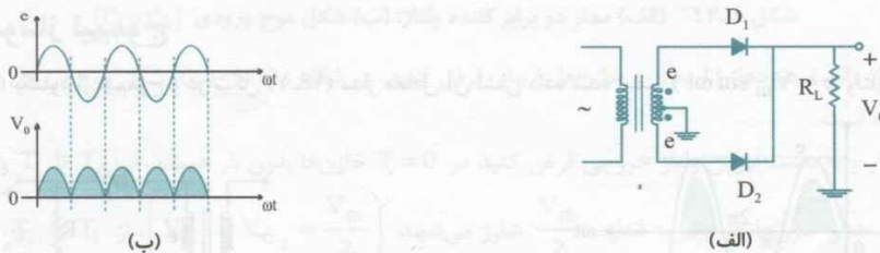
شکل ۱۷-۱ (الف) مدار یکسوساز تمام‌موج، (ب) شکل موج‌های ورودی و خروجی
