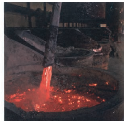
شکل ۱۸- فرایند هال برای تولید آلومینیم از Al_2O_3
