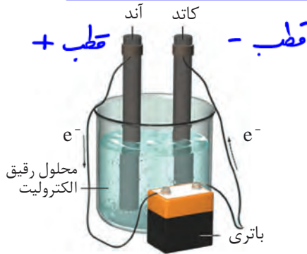
شکل ۱۱- تجزیه آب به گازهای هیدروژن و اکسیژن با مصرف انرژی الکتریکی
