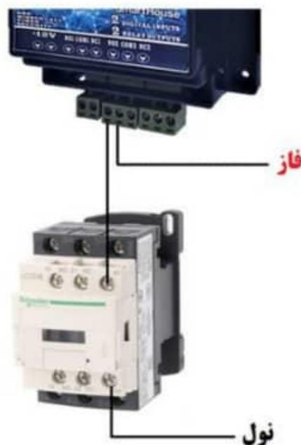
مطابق تصویر فاز پس از ورود به COM1 و خروج از NO1 وارد ترمینال A1 کنتاکتور شده و ترمینال A2 کنتاکتور به نول وصل شده است.
