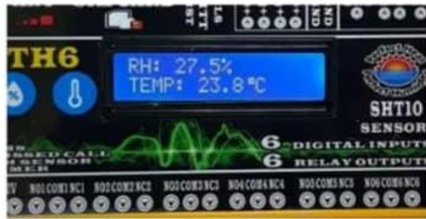
دستگاه پس از روشن شدن در صورتیکه طول سیم سنسور مناسب بوده و اتصالات سنسور صحیح باشد ، دما و رطوبت را پس از لود شدن روی صفحه LCD نمایش خواهد داد. همین مقادیر روی نرم افزار اندروید و همچنین با ارسال پیامک Temp به دستگاه ، قابل مشاهده اند. دستگاه می تواند این مقادیر را برای مدیر دستگاه در هر کجای کشور باشد مخابره کند.
