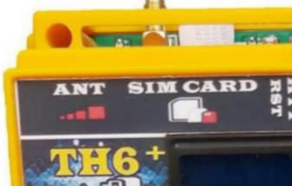
دقت فرمایید قبل از قرار دادن سیم کارت روی دستگاه آن را روی یک تلفن همراه قرار دهید ، پین کد آن را ( در صورت وجود ) بردارید ، با آن پیامک ارسال کنید و تماس بگیرید تا از سلامت سیم کارت اطمینان حاصل یابید. سیم کارت باید در سایز بزرگ بوده و پد فلزی آن روی دندانه های سوکت سیم کارت قرار گیرد.
