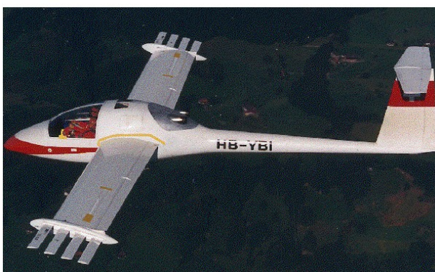
شکل .. یک هواپیمای با نصب نوک بال چند جهت پروازی
