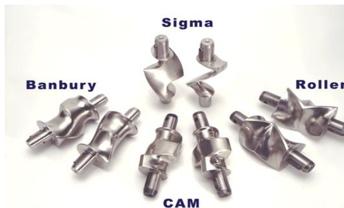
شکل ۳) تعدادی از پره های پر کاربرد در مخلوط کننده های داخلی
