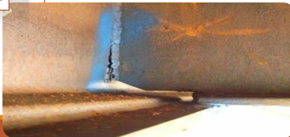
ترک قابل توجه در جوش دیده میشود. مقطع به صورت بالقوه قابلیت شکست دارد.
