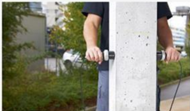
تست التراسونیک بتن (UPV)
