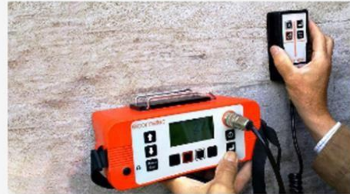
آزمایش هافسل (پتانسیل خوردگی بتن)
