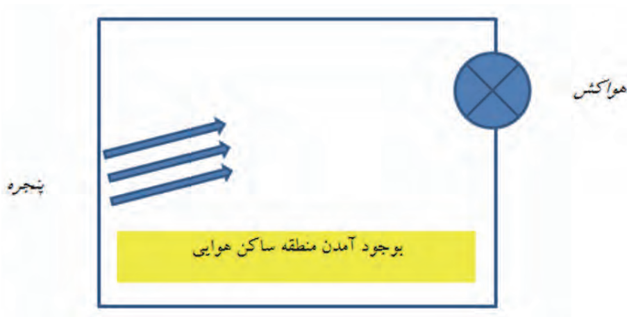
شکل ۱۳- ایجاد منطقه ساکن هوایی در سطح جوجه‌ها در صورت نصب هواکش‌ها در ارتفاع خیلی بالا
