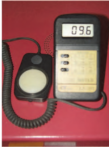
شکل ۲۰- لوکس متر برای کنترل شدت نور در سالن‌های مرغداری
