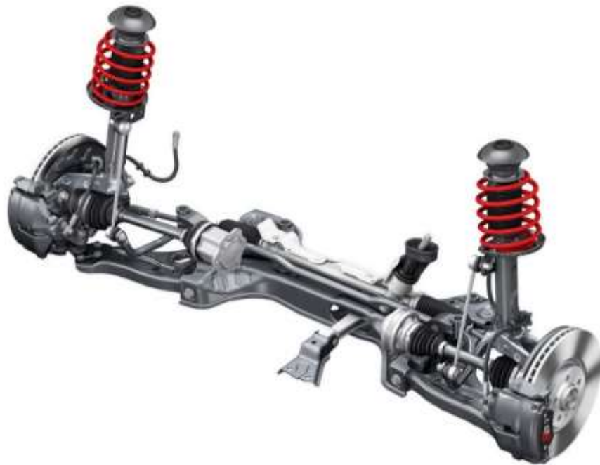
شکل ۲. سیستم تعلیق مک فرسون در تعلیق جلو
