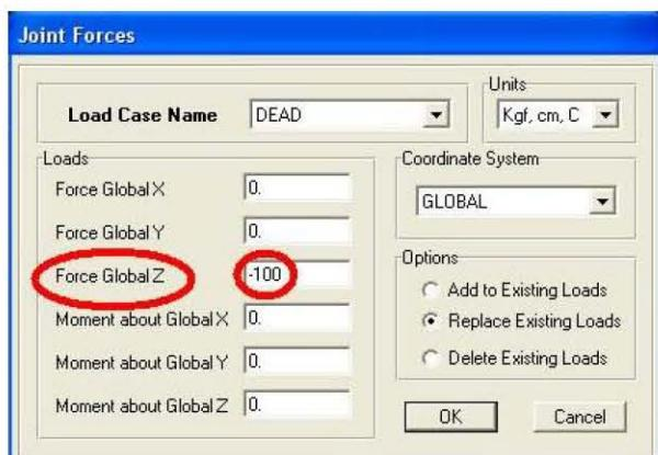
پس از اینکار در نقطه بارگذاری مقدار بار 100 ، رو به پایین وارد میگردد که نمایانگر بار واردہ به سازه می باشد.(دلیل انتخاب مقدار 100 برای بارگذاری اینست که با اینکار می توان درصد نیروی واردہ بر تمام اعضاء را بدست آورده و بدینوسیله میزان بار قابل تحمل توسط سازه را تخمین زد).
