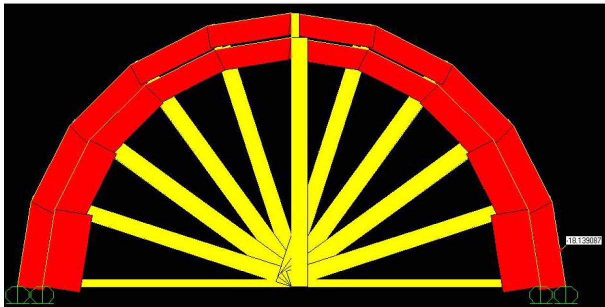
همانطور که در شکل بالا مشاهده میکنید ضخامت رنگهای نشان دهنده تنشهای اعضاء خیلی زیاد است و خود اعضاء به سختی دیده می شوند. برای کنترل و تعیین ضخامت مناسب آنها میتوان به همان روش قبل به پنجره Member Force Diagram for Frames رفته و در قسمت Scaling با انتخاب گزینه Scale Factor مقدار عددی روبروی آنرا تغییر دهیم تا ضخامت رنگها مناسب گردد.
