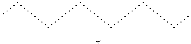
شکل ۲-۲ چند مثال برای سیگنال های گسسته (محور افقی: زمان، محور عمودی: کمیت فیزیکی، محورها رسم نشده اند) الف و ب- پیوسته در زمان، گسسته در دامنه (الف- پررودیک، ب- غیر پررودیک)، پ- گسسته در زمان و دامنه (پررودیک)
