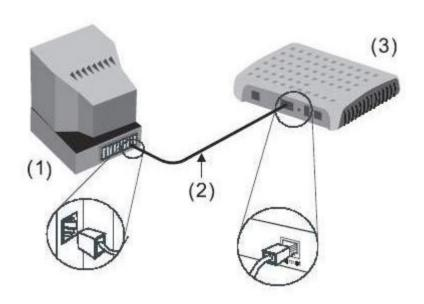
**توجه:** جهت وصل کردن مودم به Hub یا Switch از یک کابل Cross-over استفاده شود . کابل موجود درون جعبه ی مودم از نوع Straight-through می باشد و جهت برقراری ارتباط مستقیم بین مودم و کامپیوتر استفاده می شود. همچنین طول کابل بکار رفته نباید بیش از 100 متر باشد.
