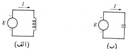
شکل ۱۱-۲ emf متناوب اعمال شده (الف) به عنصر القاوی خالص؛ (ب) به عنصر ظرفیتی خالص.
