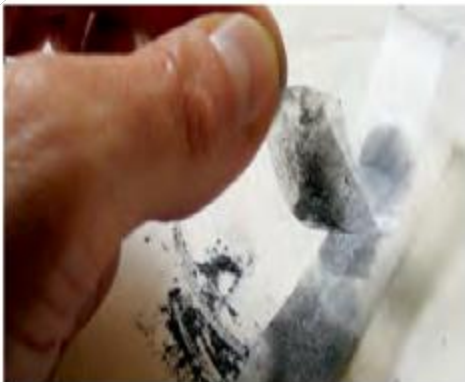
شکل ۴- تهیه گرافن با استفاده از نوار چسب
