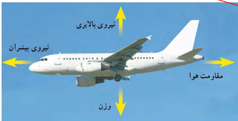
شکل ۶ - وقتی نیروهای وارد بر هواپیمای در حال پرواز متوازن باشند، تغییری در حرکت هواپیما ایجاد نمی‌شود.
