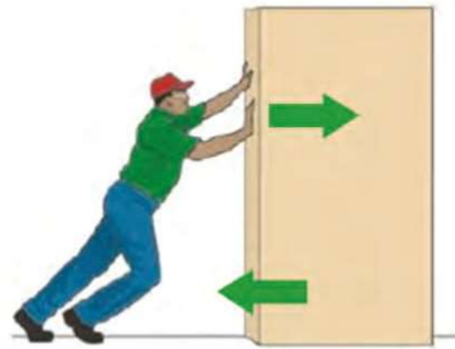
شکل ۲- شخصی به جعبه ساکن نیرو وارد می‌کند ولی جعبه حرکت نمی‌کند زیرا نیروی روبه جلو با نیروی اصطکاک رو به عقب هم اندازه‌اند.
