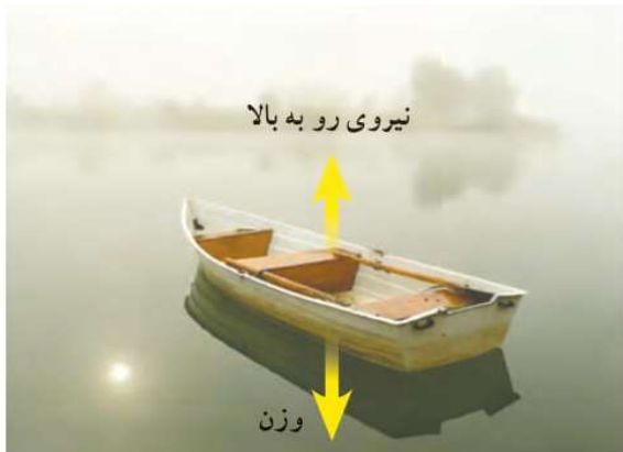
شکل ۵ - نیروی رو به بالایی که از طرف آب به قایق وارد می‌شود هم اندازه با وزن قایق است، بنابراین قایق روی آب به حالت تعادل باقی می‌ماند.
