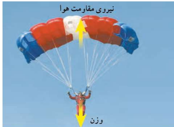
شکل ۴ - وقتی نیروی وزن وارد بر چتر باز و نیروی مقاومت هوا هم اندازه باشند، چتر باز با سرعت ثابت به طرف زمین حرکت می‌کند.
