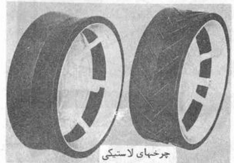
شکل ۴-۱۷: انواع چرخهای فشاردهنده.
