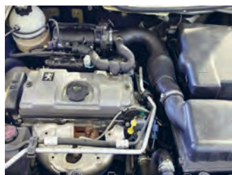
۴ اتصالات لوله‌های انتقال هوا
