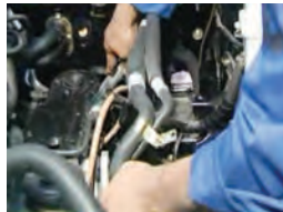
شیلنگ‌های بخاری و تهویه مطبوع جدا شوند.
