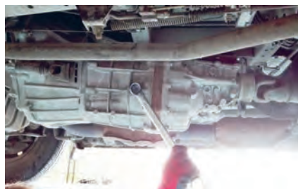
شکل ۴-۴- روش بررسی سطح و رنگ روغن جعبه‌دنده محرک عقب
