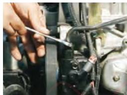
لوله‌ها و شیلنگ‌های فرمان هیدرولیک باز شوند.
