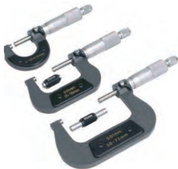
شکل ۳۰-۸. میکرومتر با اندازه‌های مختلف
