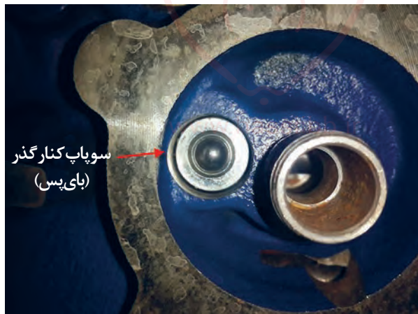
شکل ۱۶-۳- سوپاپ کنار گذر قرار داده شده در مدار روغن کاری موتور
