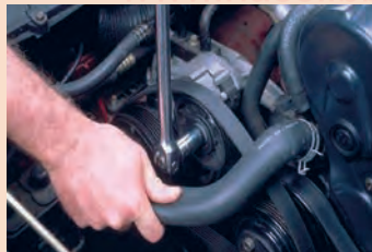
۲ تسمه سفت‌کن شل شود
