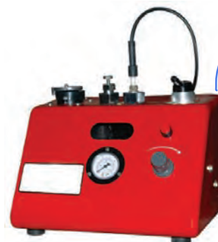
شکل ۳۷-۸- دستگاه شمع پاک‌کن با قابلیت آزمایش شمع
