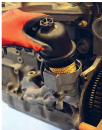
شکل ۱۸-۳- فیلتر نوع کارتریجی
