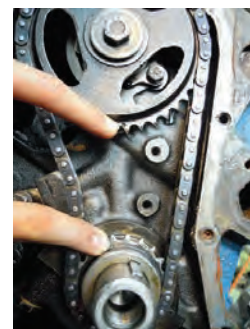
تایم موتور نوع چرخ دنده و زنجیر (پیکان ۱۶۰۰)
