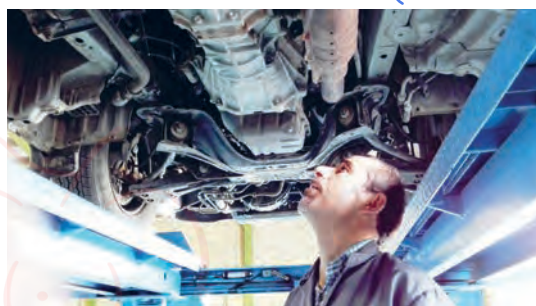
شکل ۴-۶- قرار گرفتن خودرو روی جک بالابر و دیدن محل های احتمالی نشتی
