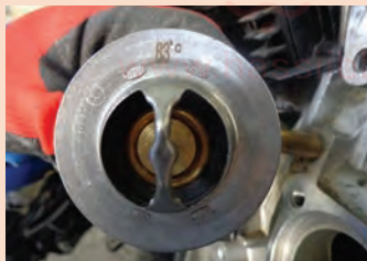
۵ ترموستات مناسب انتخاب شود. گرم - سرد
