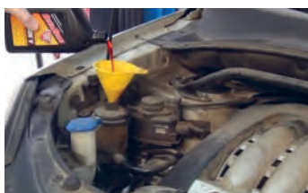
۸ مخزن تا حد مجاز دوباره پر شود.
