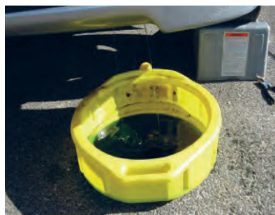
شکل ۲۷-۷- روش های تخلیه مایع خنک کننده
