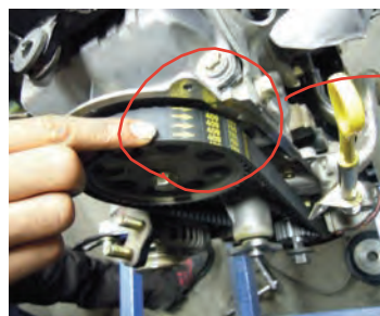
۷ تسمه تایم در جهت کشش (گردش موتور) بسته شود.
