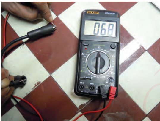
شکل ۳۸-۸- آزمایش اهمی وایر شمع
