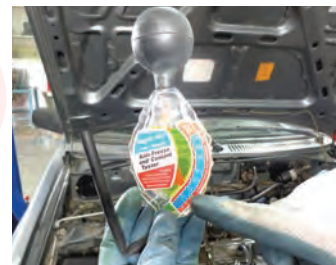
بررسی کیفیت مایع خنک‌کننده
