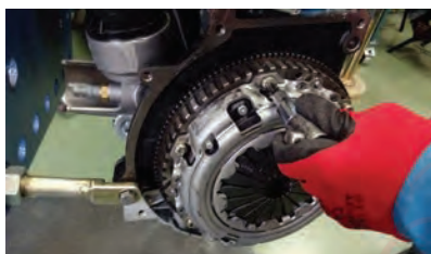
۲ مجموعه کلاچ از موتور جدا شود.
