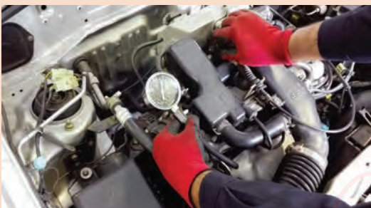
۴- مقدار فشار کمپرس تک تک سیلندرها خوانده و نوشته و مقایسه شود.
