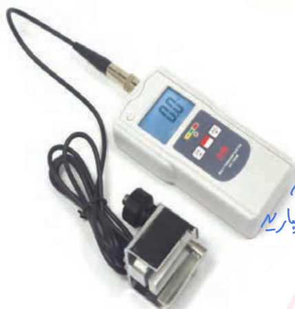
شکل ۴۰-۸- دستگاه کشش سنج تسمه تایم
