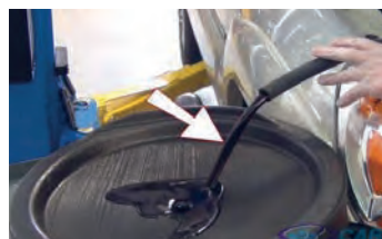
۴ هم زمان با تخلیه مایع کار کرده، مایع تازه به مخزن اضافه شود.
