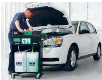
شکل ۲۷-۷- روش های تخلیه مایع خنک کننده
