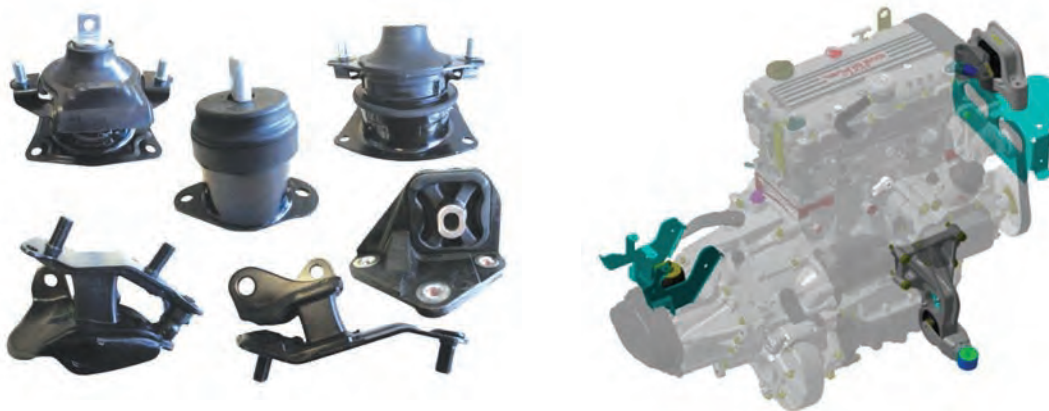
شکل ۷-۹- محل بستن دسته موتور
