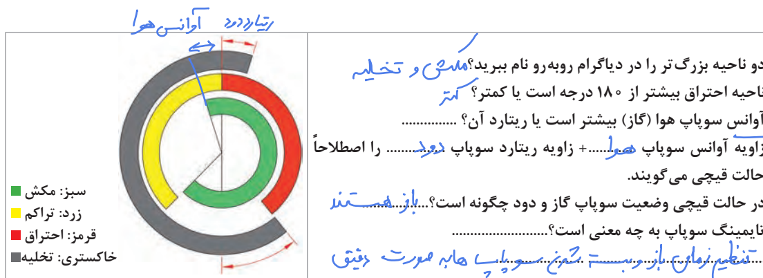
شکل ۲-۸- نمودار تایمینگ سوپاپ
