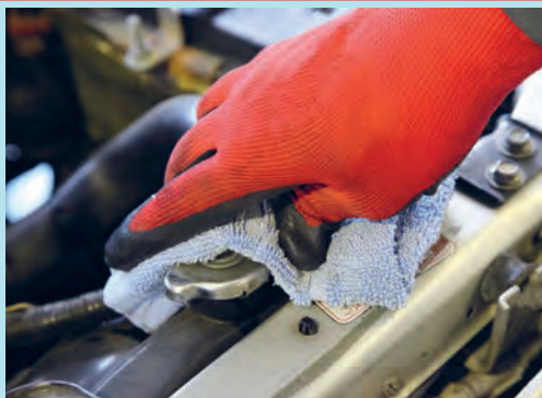
شکل ۷-۱۷- پاشش آب رادیاتور
