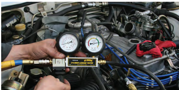
شکل ۲۵-۸- دستگاه نشتی سنج موتور
