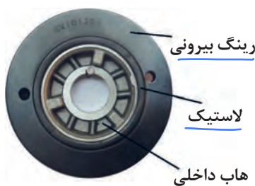
شکل ۹-۲. پولی نوسانگیر (منجیدار)
