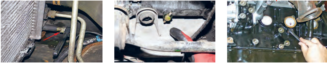
شکل ۷-۲۸- انواع پیچ تخلیه مایع خنک کننده موتور
