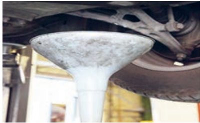
۱ مخزن جمع‌آوری روغن کارکرده زیر خودرو قرار گیرد.
