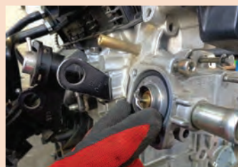
۹ مایع خنک کننده به سیستم اضافه شود
