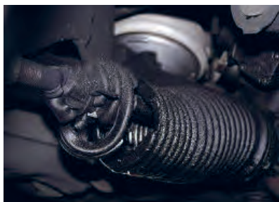
۴ نشتی گردگیرها و میل فرمان بررسی شود.
