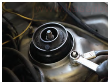
۲. بررسی سفت بودن اتصالات منفی به موتور و بدنه
