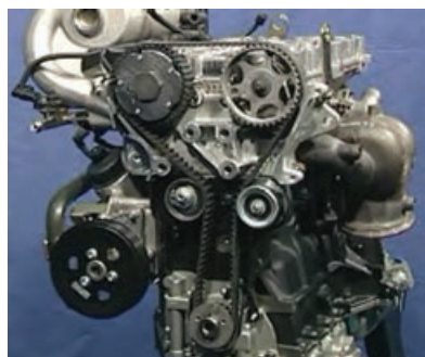
تایم موتور نوع دو میل سوآپ رو، نوع پولی و تسمه
