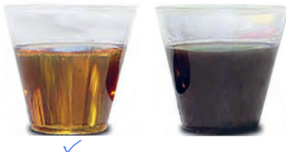
شکل ۶-۴ تفاوت رنگ مایع هیدرولیک ترمز نو و کارکرده
