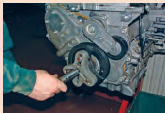
۵ پولی سرمیل لنگ خارج شود.
