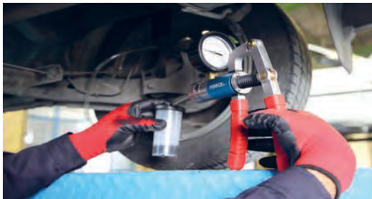
شکل ۱۲-۶- نمونه‌ای از دستگاه خلأیی هواگیری سیستم ترمز
