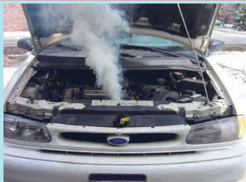
شکل ۷-۱۷- پاشش آب رادیاتور
