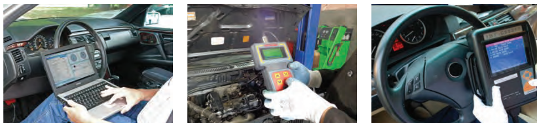
شکل ۱۷-۸- چند نمونه دستگاه عیب یاب
