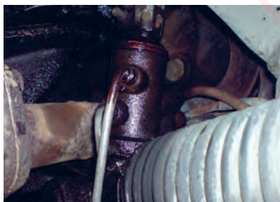
۲ نشتی شیر هیدرولیک فرمان (تقسیم‌کننده) بررسی شود.
