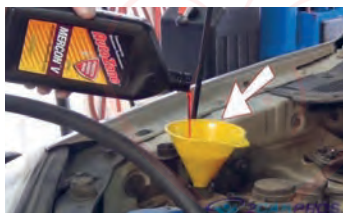
۲ مخزن از مایع تازه پر شود.
