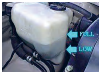
۸ کنار مخزن انبساط ۲ علامت Max(full) و Min(low) وجود دارد. سطح مایع باید بین این دو خط باشد. محدوده ای مجاز مایع خنک کننده چیست؟
