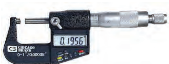
شکل ۲۹-۸. میکرومتر خارج سنجی دیجیتال
