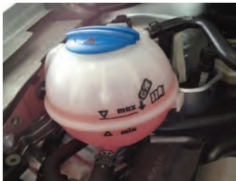
بررسی سطح مایع خنک‌کننده
