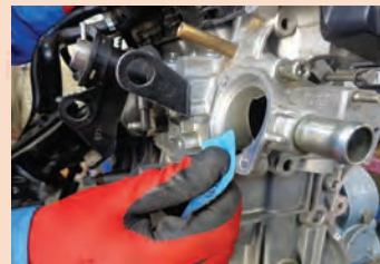
۶ ترموستات به صورت درست در جای خود قرار گیرد. (سوپاپ حباب گیر به سمت بالا)
