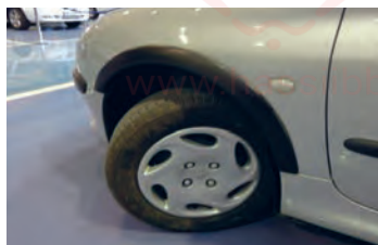
۵ هم‌زمان با تعویض مایع، فرمان به چپ و راست چرخانده شود.
