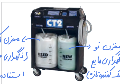
شکل ۷-۳۰- دستگاه تخلیه، شست و شو و شارژ مایع خنک کننده
