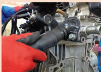
۸ اول رابط به یوت ترموستات وصل شود
