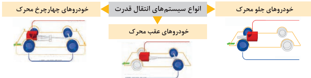
شکل ۱-۲۰- انواع سیستم انتقال قدرت
