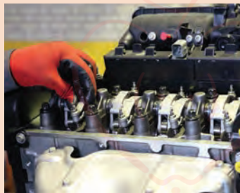
۲. حالت قیچی در سیلندرهای قرینه تنظیم شود.
