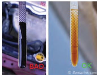
بررسی کیفیت روغن موتور
