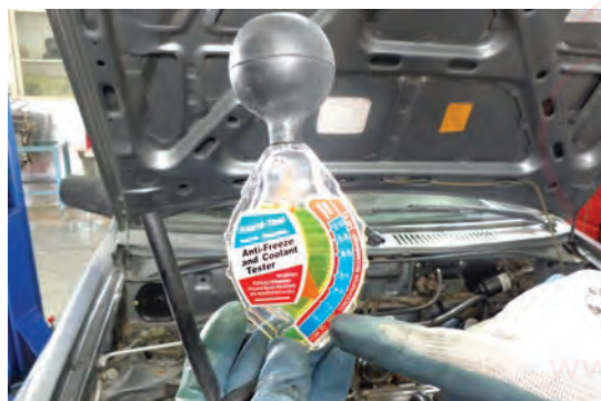
شکل ۷-۸- روش استفاده از هیدرومتر
