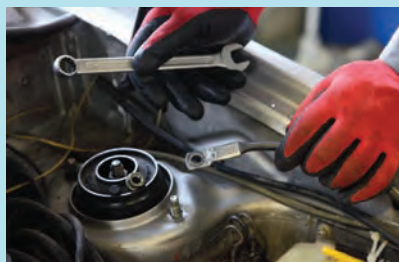
شکل ۲۶-۱- جداکردن اتصالات منفی بدنه
