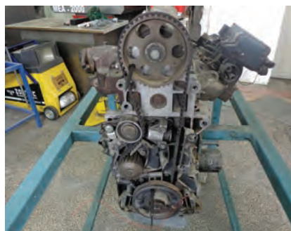
تایم موتور تک میل سوآپ رو، نوع پولی و تسمه (پژو ۴۰۵)
