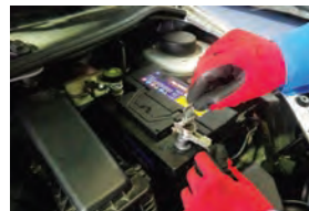
اتصالات باتری جدا شود.
