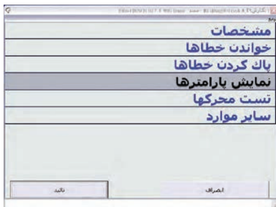
شکل ۱۹-۸. نمونه‌هایی از اطلاعات خوانده شده دستگاه عیب‌یاب
