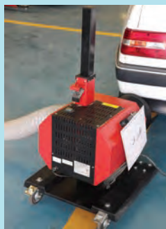
شکل ۲۰-۸- استفاده از دستگاه آگزوز فن
