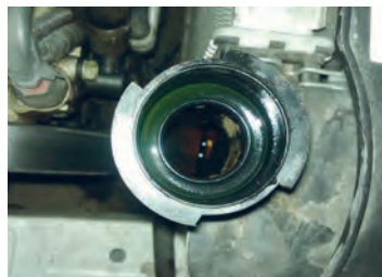
۷ در صورت چرب بودن سطح مایع، وجود زنگ زدگی روی سطح مایع یا کدر بودن آن، مایع خنک کننده باید تعویض شود (پس از رفع عیب)
