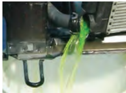
شیلنگ‌های سیستم‌های خنک‌کاری جدا شوند.
