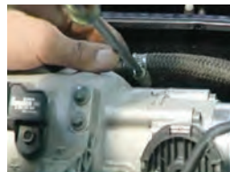
شیلنگ‌های سیستم سوخت‌رسانی جدا شوند.
