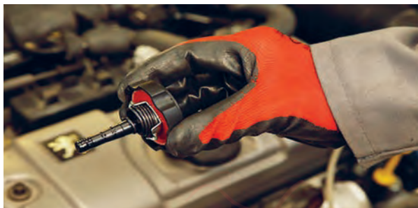
شکل ۵-۷ - شاخص های روی درپوش مخزن مایع هیدرولیک فرمان
