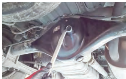
شکل ۴-۵- روش بررسی سطح و رنگ روغن دیفرانسیل محرک عقب
