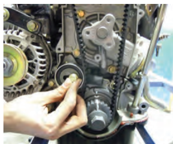
۶ تسمه سفت‌کن نو به صورت آزاد (شل) بسته شود.
