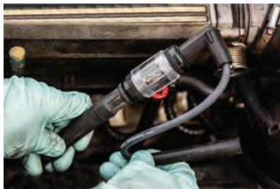
شکل ۸-۱۶- دستگاه آزمایش جرقه
