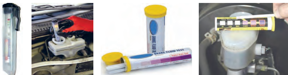
شکل ۶-۶- آزمایش کیفیت مایع هیدرولیک ترمز
