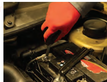
۱. بررسی اتصالات مثبت و منفی باتری
