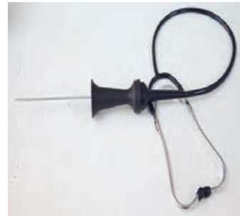
شکل ۱۴-۲. گوشی مکانیکی (استاتسکوپ) و ابزار بررسی فاصله تسمه و شیار پولی برای تشخیص دادن به صدای بلبرینگ ها از چه وسیله ای استفاده می شود؟
