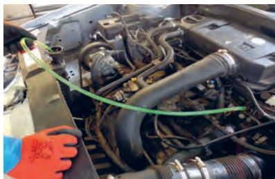
۴ به مایع خارج شده از لوله شفاف توجه شود و زمانی که مایع بدون حباب از آن خارج شد، پیچ هواگیری سفت و نشستی مدار بررسی شود.
