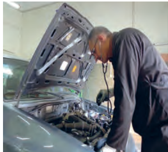
شکل ۱۴-۲. گوشی مکانیکی (استاتسکوپ) و ابزار بررسی فاصله تسمه و شیار پولی برای تشخیص دادن به صدای بلبرینگ ها از چه وسیله ای استفاده می شود؟
