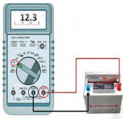
شکل ۱۱-۷ اندازه گیری ولتاژ
