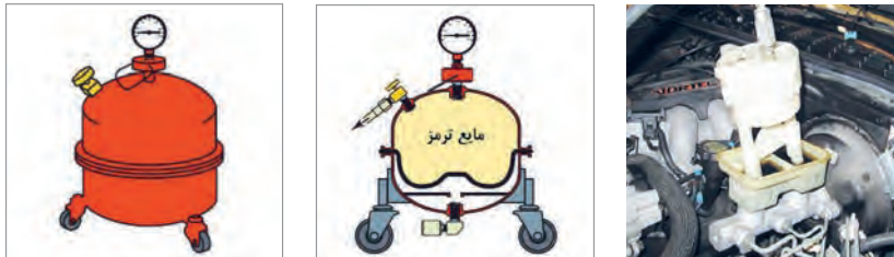
شکل ۱۴-۶- تعویض و هواگیری سیستم هیدرولیک ترمز با دستگاه تزریق تحت فشار
