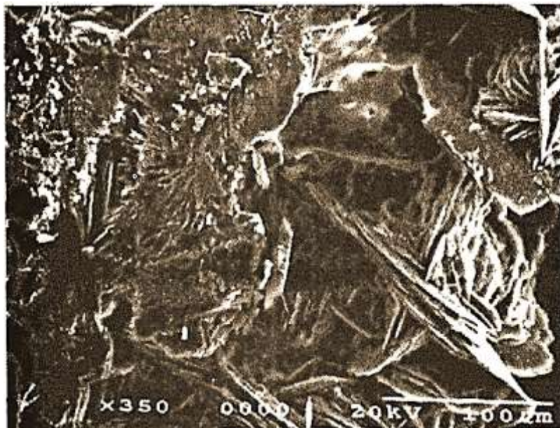
شکل ۴-۳- تصویر میکروسکوپ الکترونی از غشای دارای رسوب سولفات
