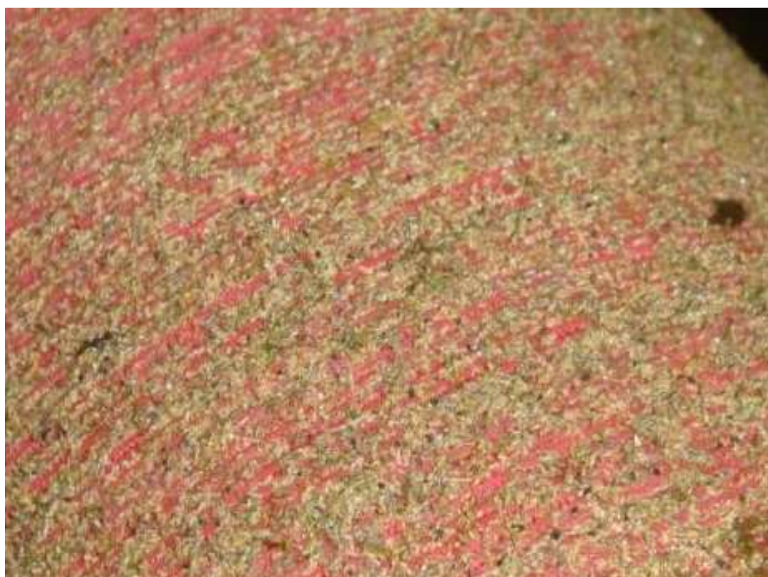
شکل ۵-۴۹- آب شیرین کن جزیره هنگام - نمونه ای از گرفتگی فیلترهای دیسکی
