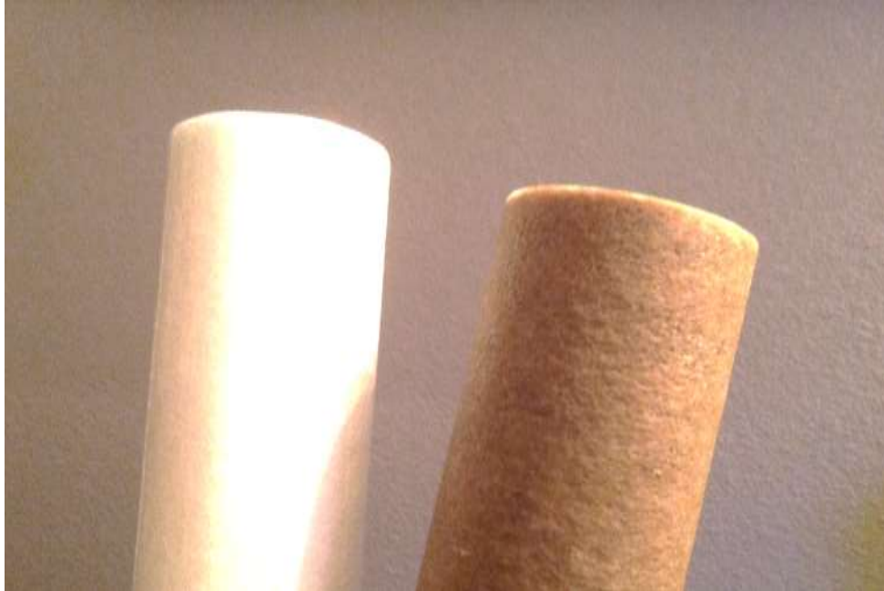
شکل ۴-۹- در سمت راست فولینگ گل و لای در فیلتر کارتریج مشاهده می شود.
