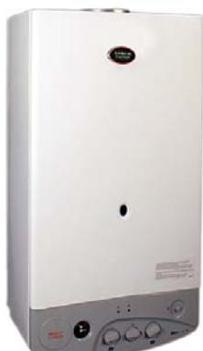
پکیج یکی از انواع وسایل گرمایشی می‌باشد که برای گرم کردن آب هر واحد به صورت مستقل بکار می‌رود. این سیستم به گونه‌ای طراحی شده است که اجزاء تشکیل دهنده آن در مجموعه کوچکی قرار دارند و با توجه به وزن کم بر روی دیوار قابل نصب شدن است. به این ترتیب با استفاده از آن، در ساختمانها نیازی به احداث موتورخانه نیست.
