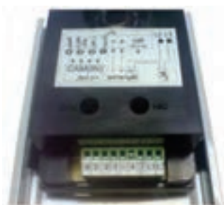
شکل ۲۵- محل تنظیم صدای بلندگو و میکروفن
